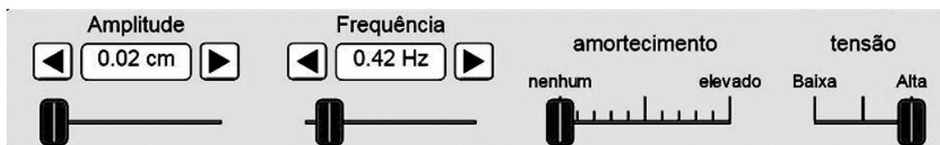
8. Altere o valor da frequência para  $f_2 = 0,83$  Hz e aguarde alguns minutos. Repita esse procedimento e altere o valor da frequência para  $f_3 = 1,25$  Hz e, depois, para  $f_4 = 1,67$  Hz. Pode-se dizer que a corda exibe mais de uma frequência natural de oscilação?
