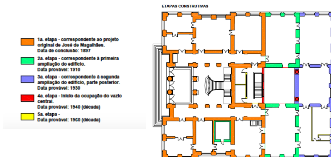
Figura 23 - Esquema das ampliações realizadas ao longo do século XX. Fonte: IEPHA, 2006, p.100
