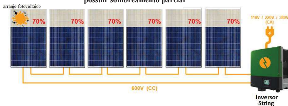
Figura 15 – Redução de energia total para um SFCR com inversor string devido o primeiro módulo possuir sombreamento parcial
