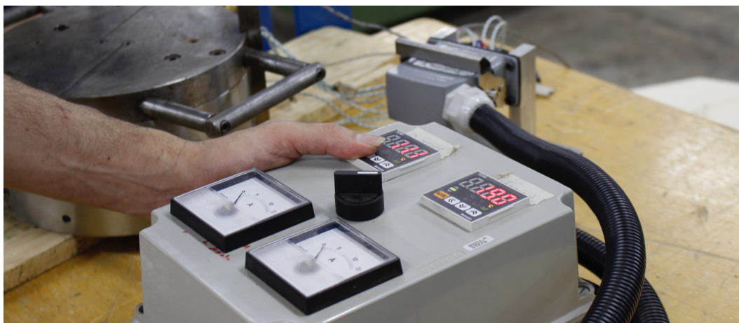
Figura 7: Central de controle de temperatura.
