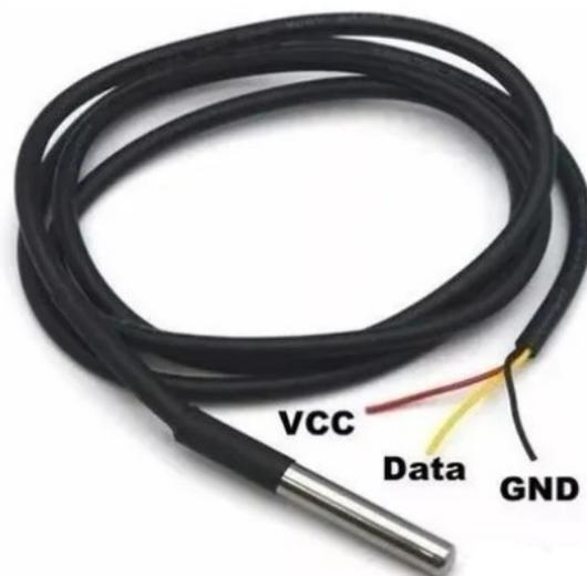
**Figura 7. 2:** Sensor de temperatura modelo DS18B20.
