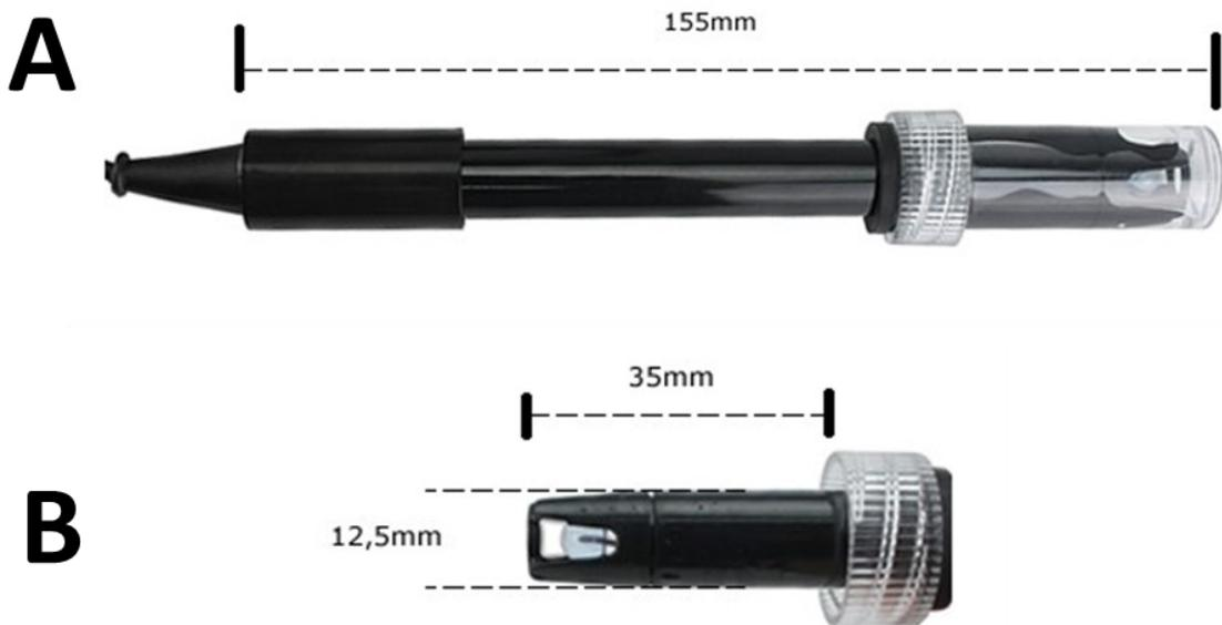
**Figura5. 3:** a) Medida do comprimento do corpo da sonda de pH – 155 mm. B) Medida do comprimento e do diâmetro do corpo da sonda que fica submerso na solução a ser medida.
