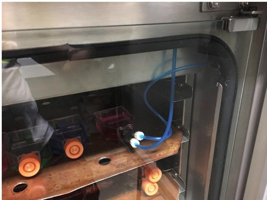
**Figura 6. 3:** Ilustração das conexões de entrada e saída do meio circulante através de agulhas de inox que atravessam uma rolha de vedação.
