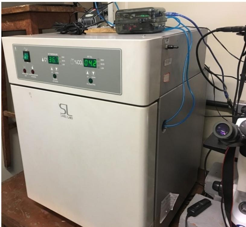
**Figura 6. 2:** Estufa de CO2 com sistema de monitoramento acoplado.
