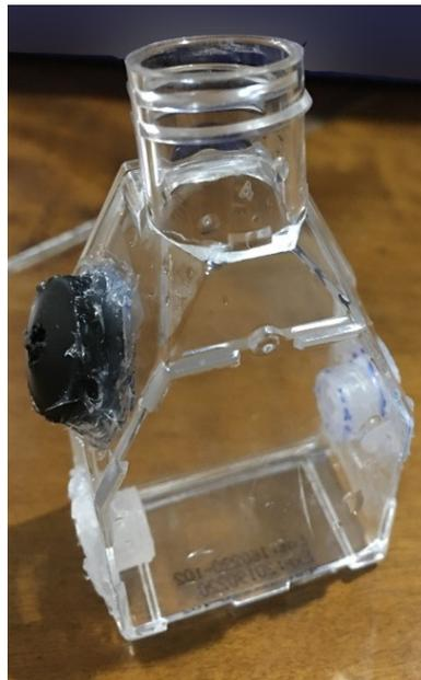
**Figura 7. 10:** Ilustração das conexões adaptadas em um frasco de cultura fixados por silicone não tóxico.
