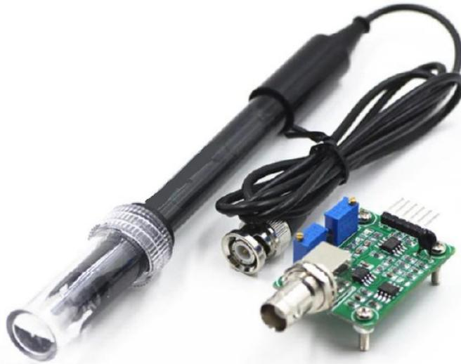
**Figura5. 2:** Sonda de pH e circuito eletrônico que constitui o módulo sensor de pH utilizado em conjunto com a placa Arduino.
