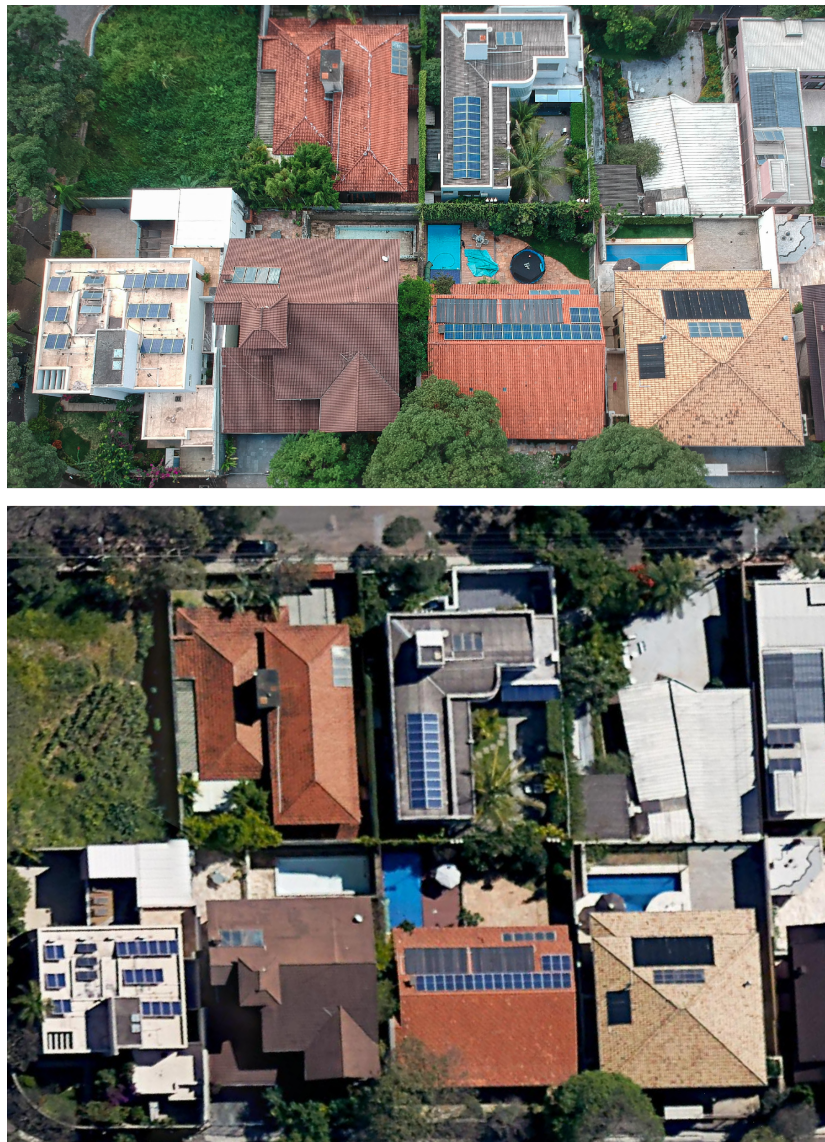
Figura 28 - Fotografia aérea produzida por drone (acima) comparada a ortofoto do Google (abaixo) no mesmo local
