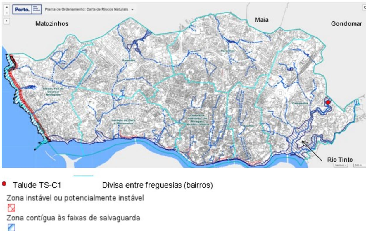
**Figura 4.18- Localização do Talude TS-C1 em Porto sobre a Carta de Riscos Naturais (Adaptada de Porto, 2003; Porto, 2020)**
