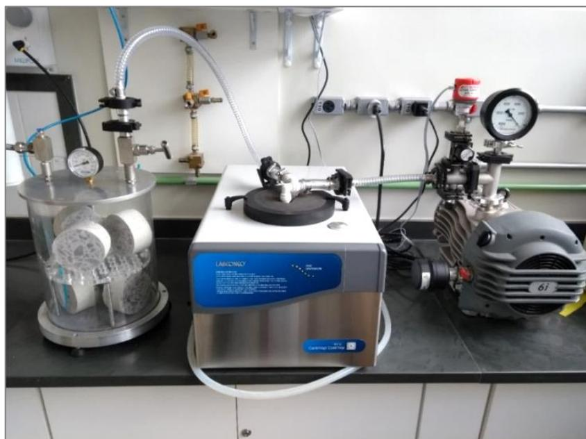
Figura 3.18 - Conjunto: câmara de vácuo, *ColdTrap* e bomba
