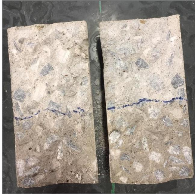
Figura 3.14 - Medição da altura de ascensão capilar após o rompimento por compressão diametral (28 dias)
