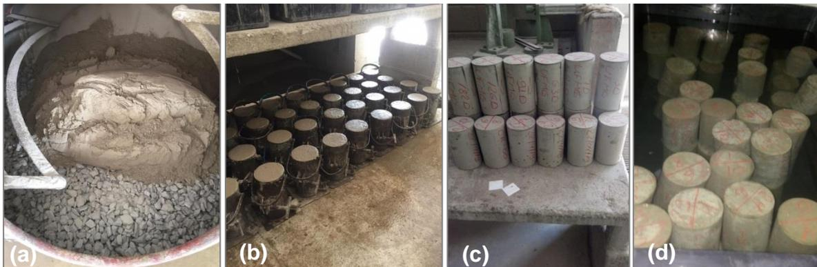
Figura 3.11 - Moldagem, identificação e cura dos corpos de prova
