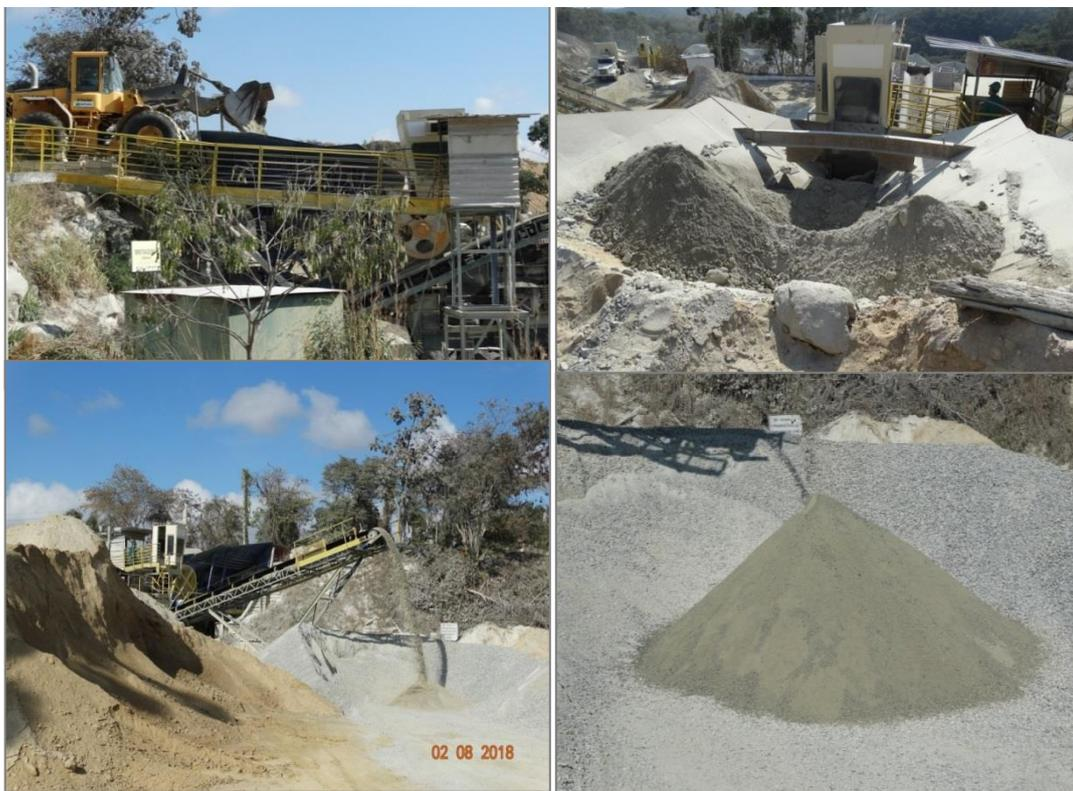
Figura 3.4 - Conjunto de britagem e peneiramento utilizado para o beneficiamento do RCFL
