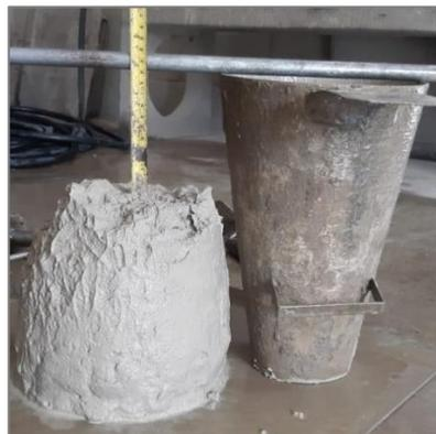
Figura 3.12 - Realização do *Slump test*
