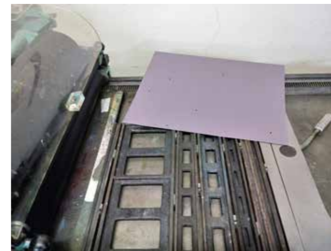
Impressão de sinais pela estrutura base no prelo Vandercook
