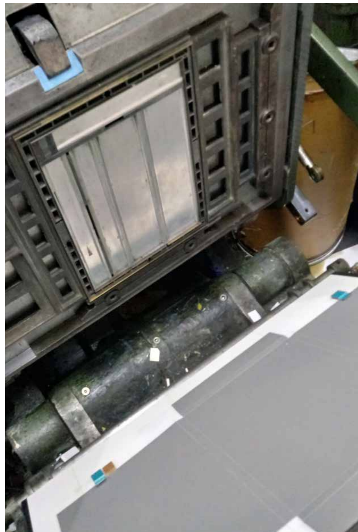
Faca de vinco da caixa na impressora platina
