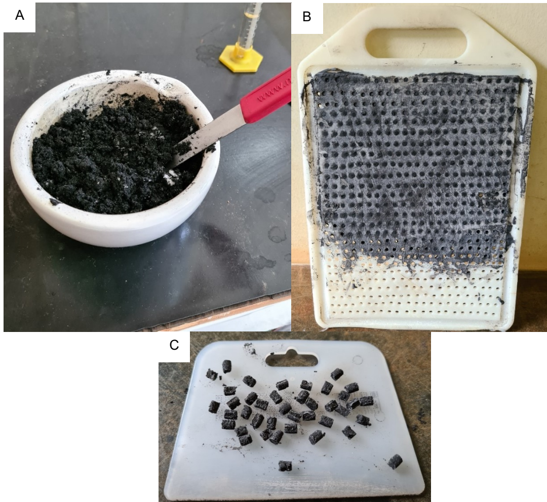
Figura 3 – Processo de preparação do fertilizante organomineral peletizado. (A) Mistura para a preparação do biochar peletizado; (B) Molde de polietileno para a incorporação da mistura e (C) Espátula plástica trapezoidal utilizada para a inserção da mistura no molde.
