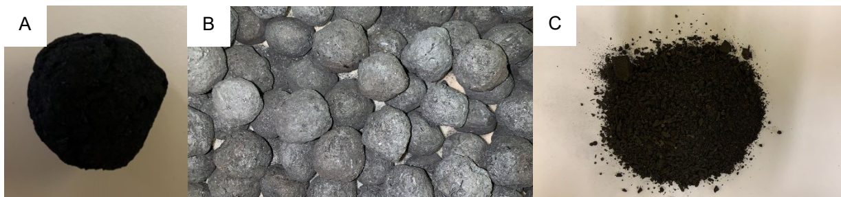
Figura 2 – (A) Confeção de esferas de 4 cm a partir do esterco bovino; (B) Esferas secas e (C) Biochar triturado.
