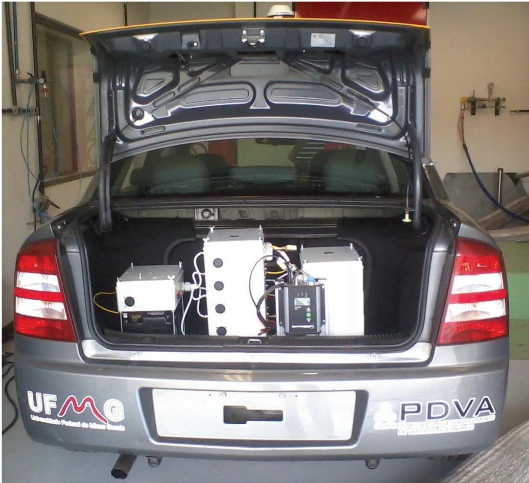
Figura 4.20: Sistema completo de Hardware implementado no CADU, sendo mostrado o porta malas do CADU e da direita para a esquerda o sistema de Alimentação composto por conversores DC/DC e uma bateria, o Sistema de Comunicação e os PCs presentes em cada nível, e por último as placas responsáveis pela interface com o veículo.
