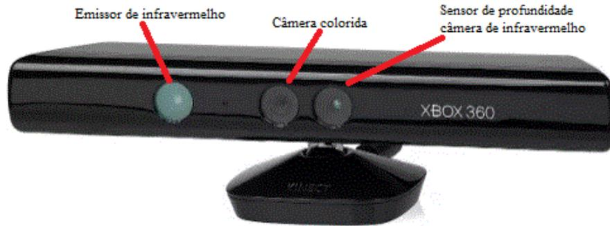
Figura 4 - Sensor Kinect XBOX 360 onde são observados da esquerda para a direita: emissor de infravermelho (IR), câmera colorida e sensor de profundidade.
