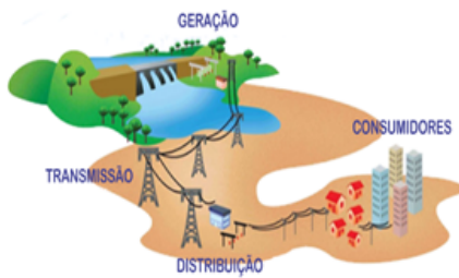
Figura 2.1: Sistema elétrico: geração, transmissão e distribuição.
