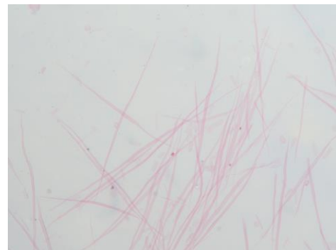
Figura 2. Fibras da espécie Luhea grandiflora objetiva 5x para mensuração do comprimento (µm).
