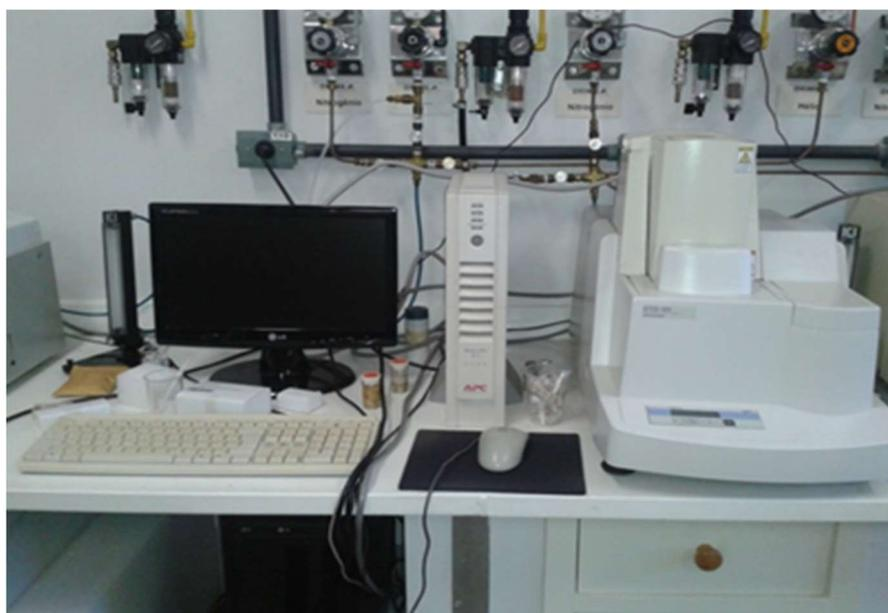
**Figura 3.4** - Difratorômetro de raios X.
