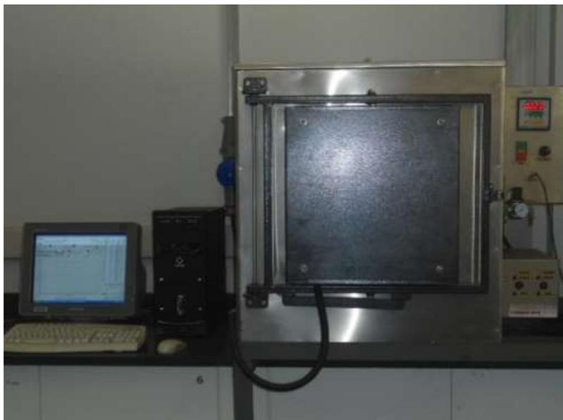
**Figura 3.16** - Forno com atmosfera controlada.
