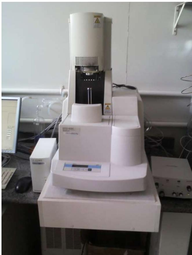
**Figura 3.7** - Equipamento para Análise Termogravimétrica e Termodiferencial – Modelo DTG 60 Shimadzu.
