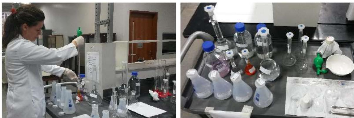
**Figura 3.11** - Etapas de titulação com solução aquosa de ácido clorídrico.
