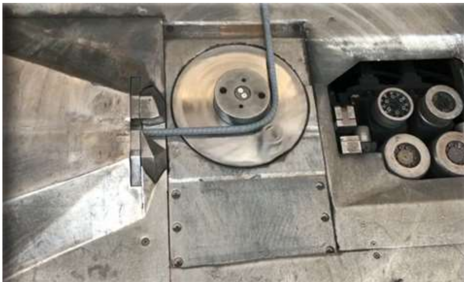
Figura 7: Foto da máquina de corte e dobra Fonte: Calixto Dias, 2018.
