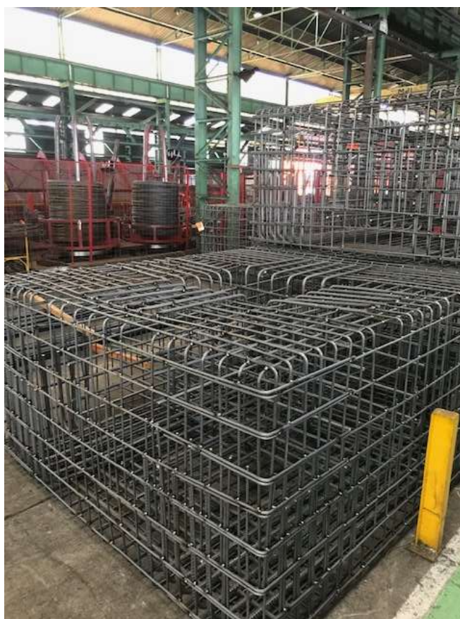
Figura 10: Foto do material (bloco) cortado, dobrado e soldado (APS). Fonte: Calixto Dias, 2018.
