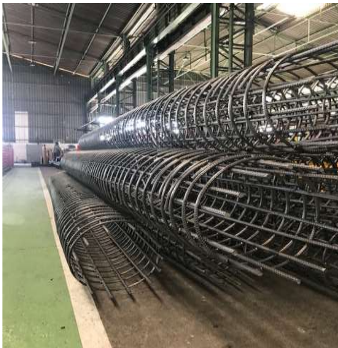
Figura 9: Foto das estacas cortadas, dobradas e soldadas (APS). Fonte: Calixto Dias, 2018.
