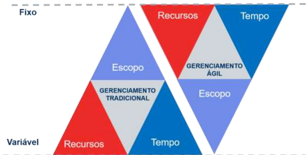
Figura 1 - Triângulo de ferro para os modelos de gerenciamento de projetos tradicional e ágil
