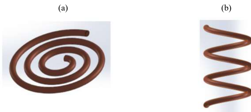
Figura 2.26: Tubos capilares (a) espiral e (b) helicoidal
