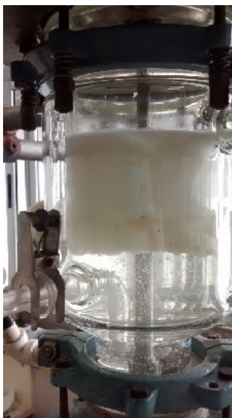
FIGURA 6.25 - Fenômeno de oclusão da fase externa no sedimentador de topo.
