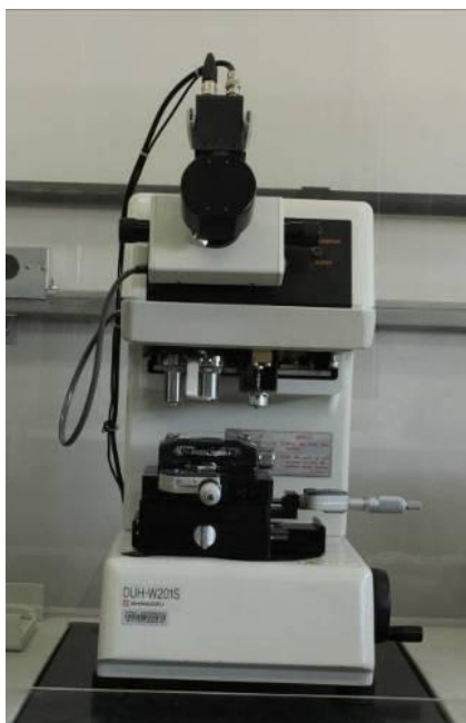
Figura 4.7: Ultramicrodurômetro Shimadzu, modelo DUH-W201S pertencente ao Laboratório Nanotec-Tribologia do Departamento de Engenharia Metalúrgica e de Materiais da EE-UFMG.
