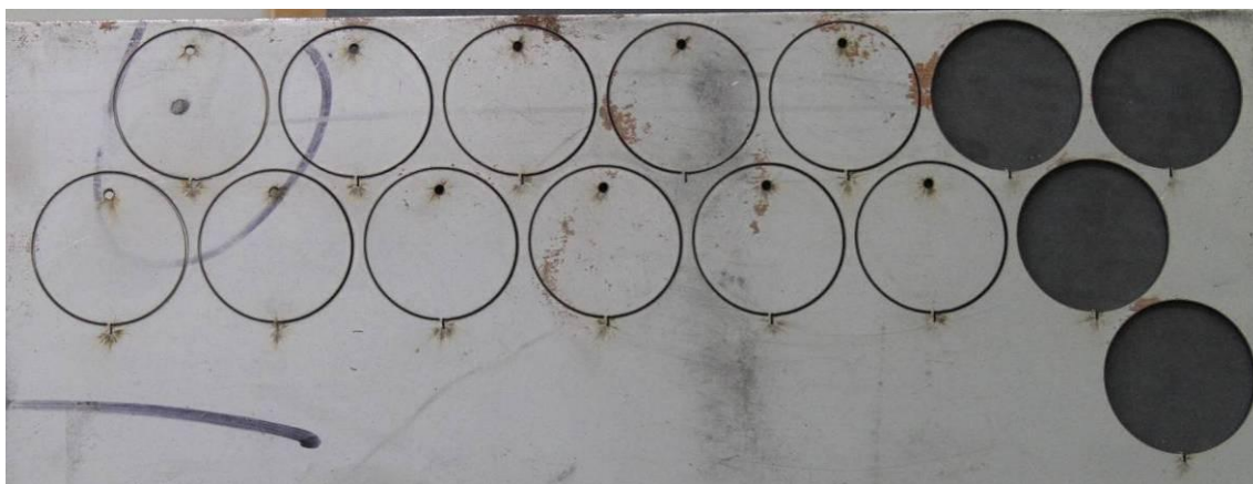
Figura 4.2: Fotografia de uma chapa com amostras cortadas a laser e algumas já destacadas.
