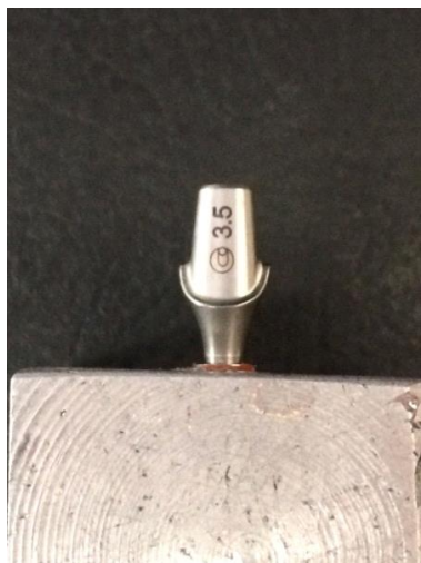
Figura 1 - Base de alumínio com instalação de implante do sistema cone morse e fixado um munhão anatômico cone morse (Neodent-Curitiba, Brasil).
