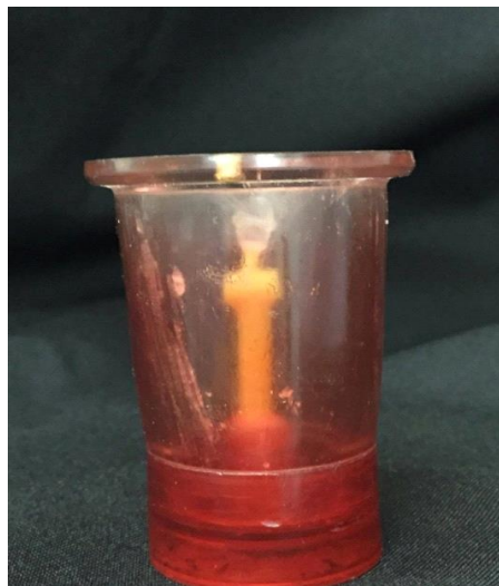
Figura 4 - Conjunto Base de borracha + Anel de borracha + Sprue principal de cera unido ao coping de VITA CAD-Waxx para os procedimentos de inclusão
