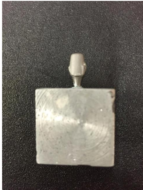
Figura 5 - Conjunto base metálica e componente protético do tipo munhão anatômico cone morse e com infraestrutura fundida em liga metálica Ni-Cr.
