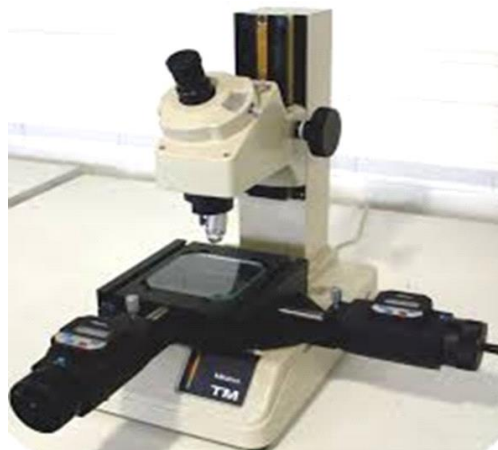
Figura 6 - Microscópio comparador óptico Mitutoyo (modelo TM 500) utilizado para as leituras da verificação da adaptação marginal.
