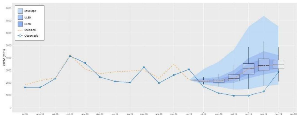
**Figura 5.72** - Série de vazões observadas e simuladas e previsão probabilística das vazões incrementais à UHE Itaipu, para a previsão de precipitação iniciada em julho/2019.
