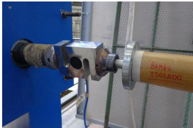
Figura 4.1.8: Barra isolada com o aparelho de apoio, no pórtico.
