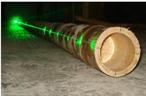
Figura 4.2.24: Feixe luminoso durante a medição da imperfeição inicial do bambu.
