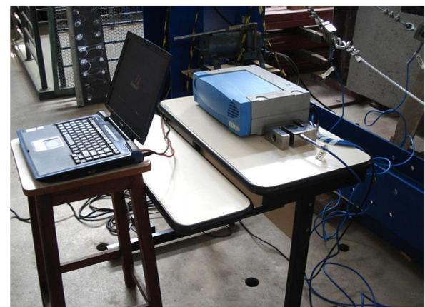
Figura 3.4.1.4: Computador portátil conectado ao SAD para registro dos dados.
