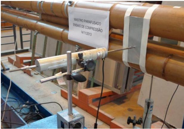
Figura 4.3.8: Fixação das chapas equalizadoras.
