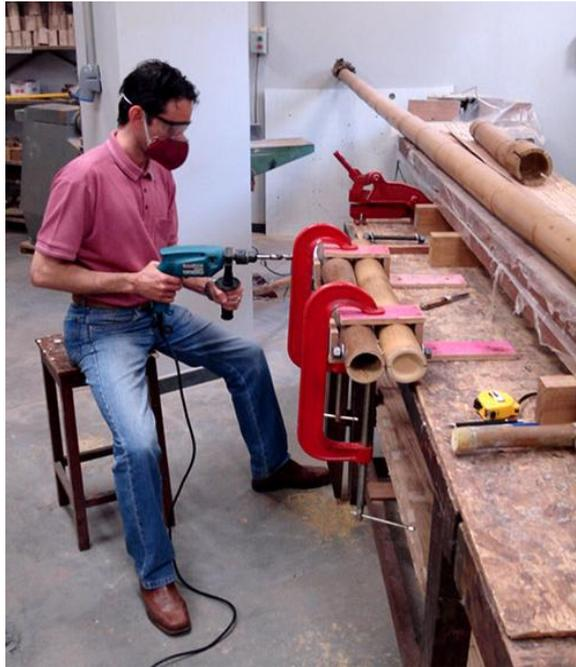
Figura 3.2.2.1: Esquema de furação das barras de bambu.
