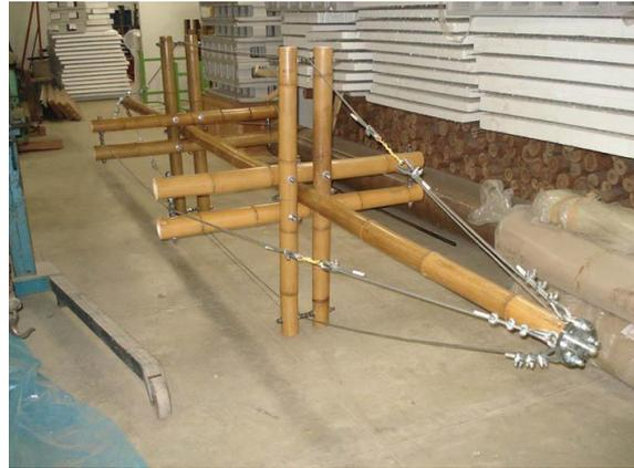
Figura 4.2.35: Segundo protótipo com os cabos de aço instalados.
