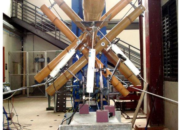
Figura 3.4.2.3: Instalação dos três DTs: um na vertical e outros dois a 45 graus.
