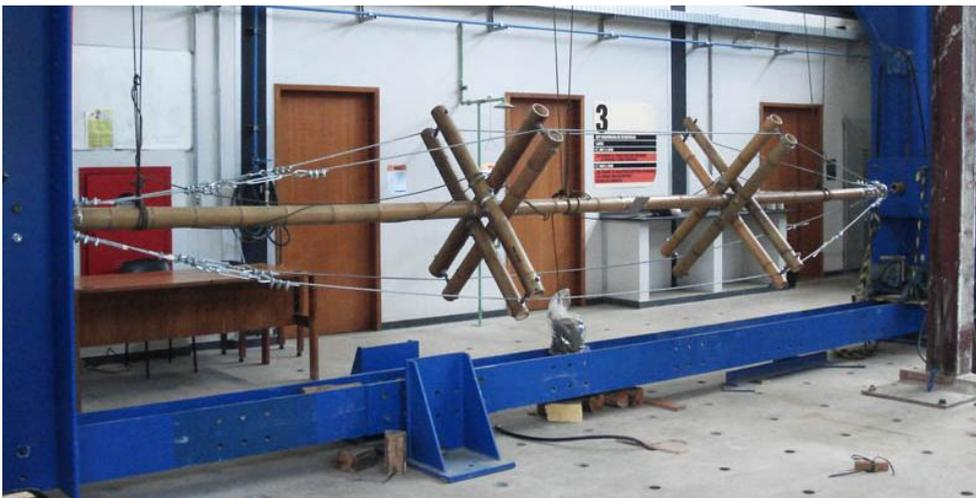
Figura 4.2.36: Segundo protótipo do mastro no pórtico de reação.
