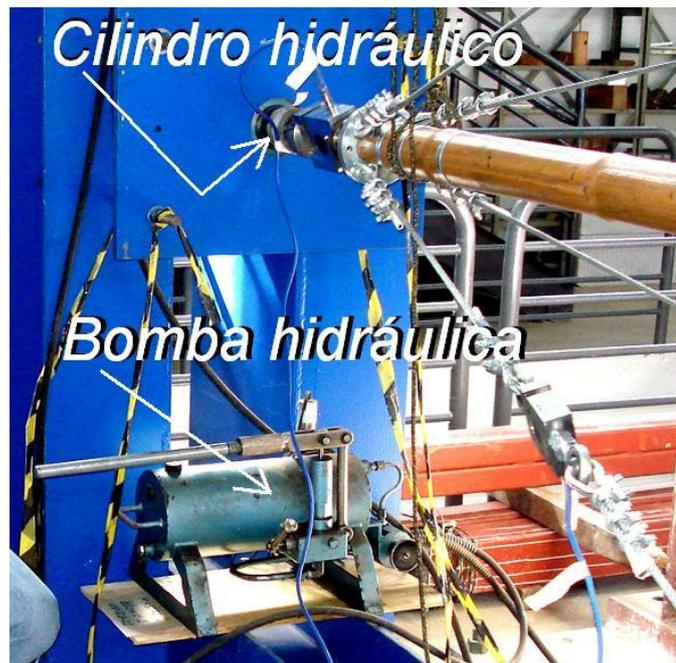
Figura 3.3.2.1: Bomba a óleo sob pressão e o cilindro hidráulico.
