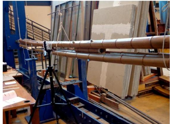
Figura 4.3.16: Linha elástica para  $P = 45$  kN – perspectiva lateral.
