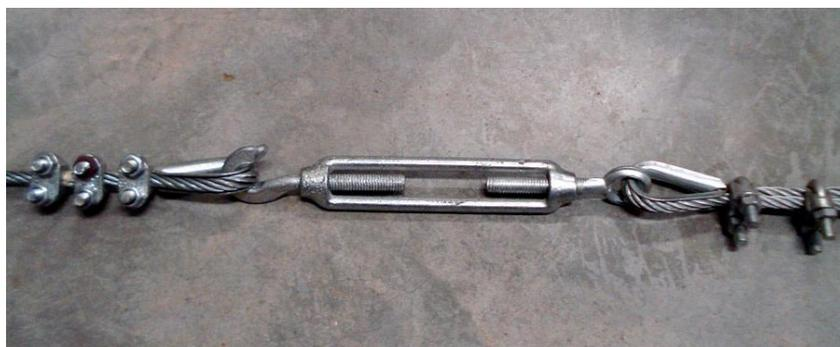
Figura 3.2.7.8: Esticadores com os cabos de aço do mastro híbrido.
