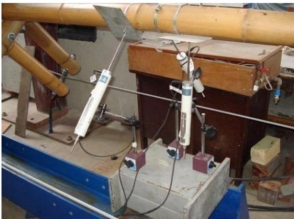
Figura 4.2.37: Instalação dos *DTs* (transdutores de deslocamento), vista 1.
