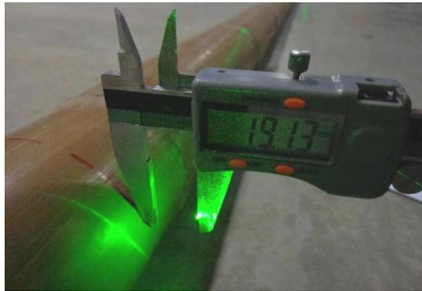
Figura 4.2.26: Medição da imperfeição inicial do bambu.
