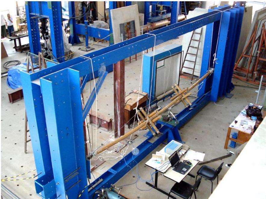
Figura 3.3.1.1: Pórtico de reação com a instalação do protótipo do mastro híbrido.
