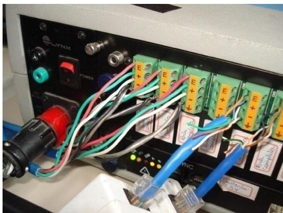
Figura 3.4.1.3: Ligação dos cabos das células de carga ao SAD.
