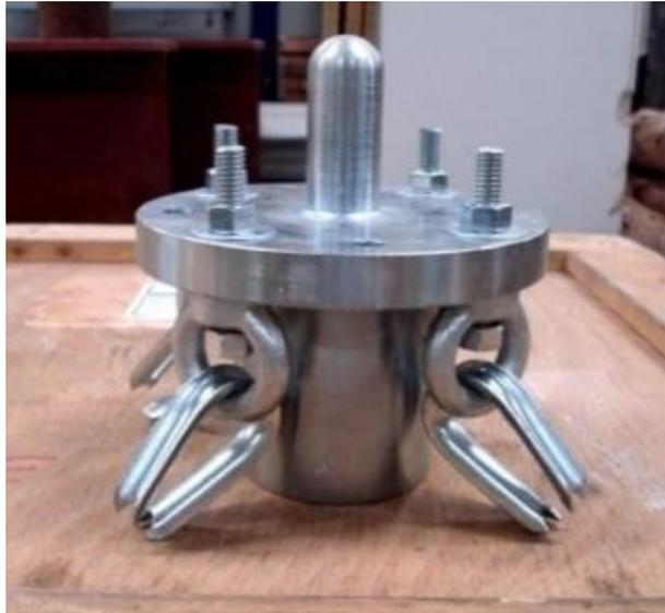
Figura 3.2.3.4: Aparelho de apoio usinado, com acessórios de fixação dos cabos de aço.
