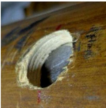
Figura 4.3.25: Penetração dos fios da rosca na parede do bambu.
