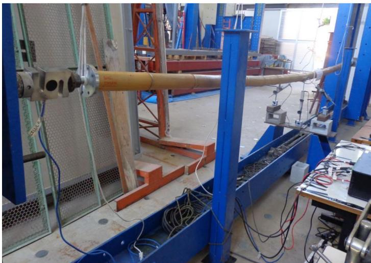
Figura 4.1.10: Flambagem da barra durante o ensaio.
