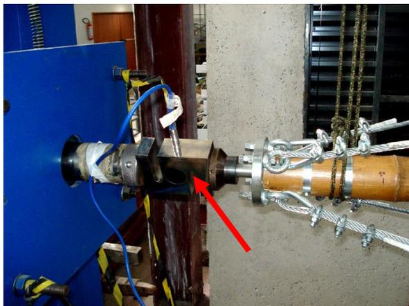
Figura 3.3.4.1: Célula de carga no sistema de aplicação de carga.
