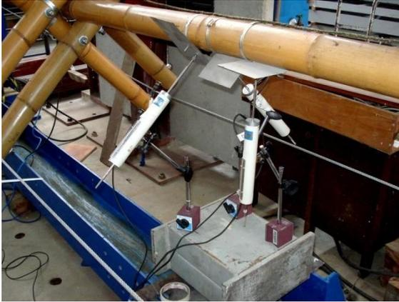
Figura 3.4.2.2: Instalação dos DTs com base imantada em placas metálica.
