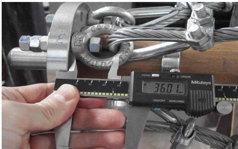
Figura 3.2.3.5: Distância entre pontos de fixação dos cabos e a extremidade da barra de bambu.
