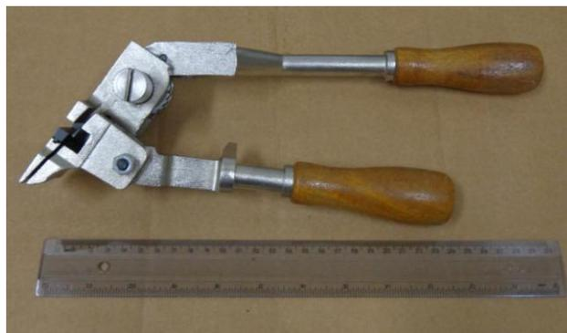
Figura 3.2.6.2: Máquina de cintamento.
