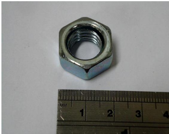
Figura 3.2.7.1: Porcas utilizadas na montagem dos protótipos dos mastros.
