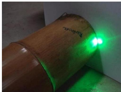
Figura 4.2.25: Extremidade do feixe luminoso na medição da imperfeição inicial do bambu.
