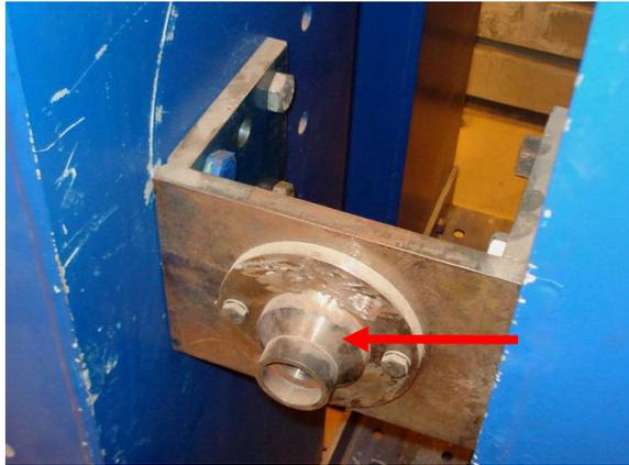
Figura 3.3.3.1: Rótula de apoio fixada em placa no pórtico.
