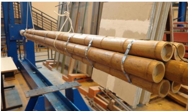
Figura 4.4.6: Mastro finalizado e instalado no pórtico de reação.
