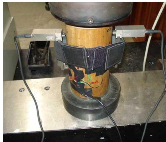
Figura 4.1.7: Instalação do "clip gage" no corpo de prova.
