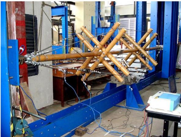
Figura 3.4.1.1: Panorama do ensaio com ligação das células de carga ao SAD.
