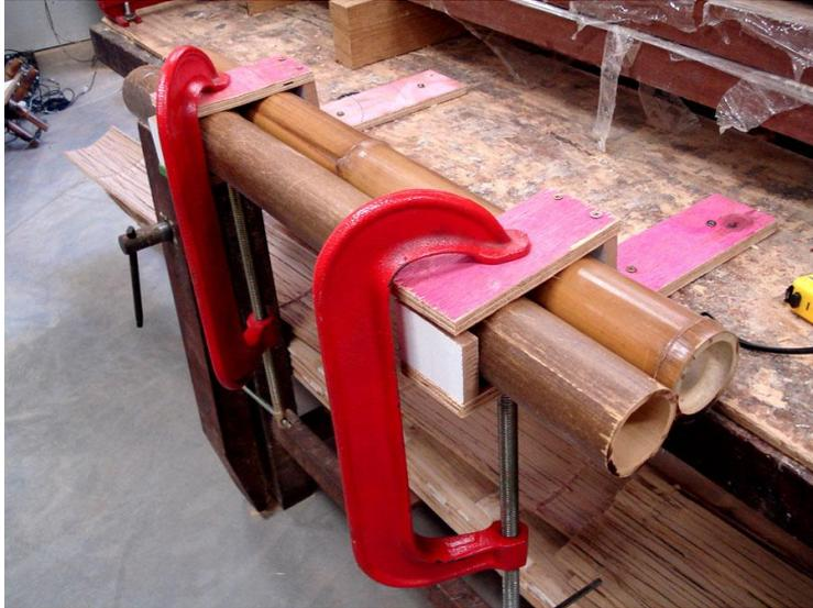
Figura 3.2.1.1: Gabarito para furo de barras de bambu.
