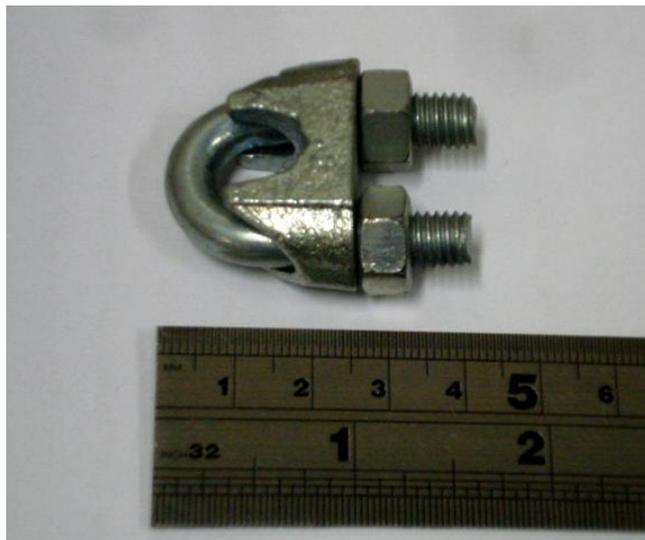
Figura 3.2.7.4: Presilhas utilizadas na fixação dos cabos de aço.
