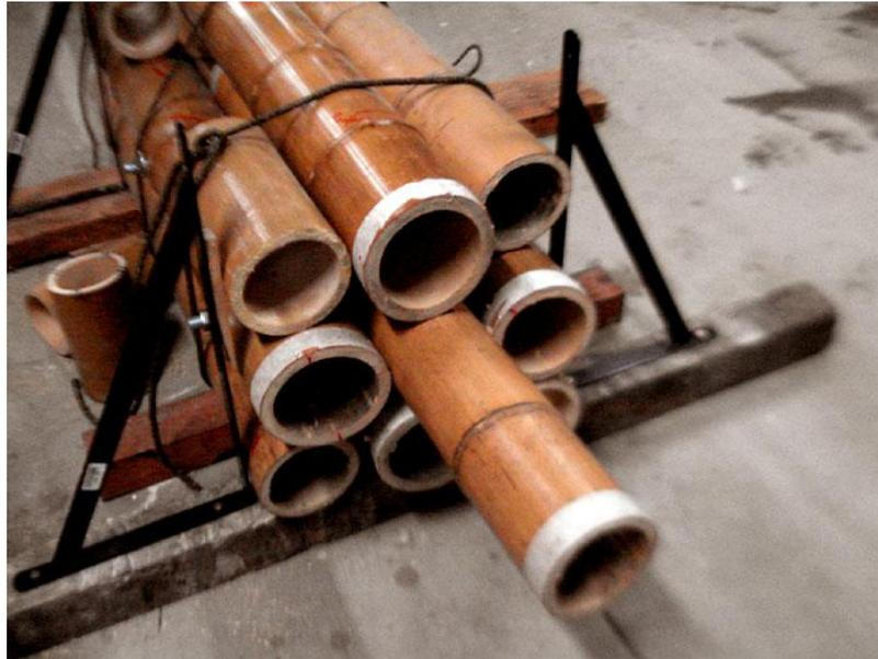
Figura 3.2.1.2: Gabarito para construção do mastro de parafusos.
