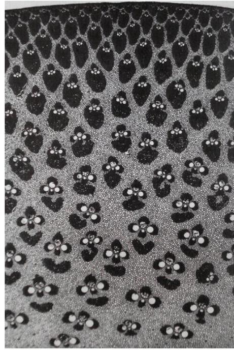
Figura 2.3.8: Parede do bambu, com a distribuição das fibras. (LIESE, 1998, p.36)
