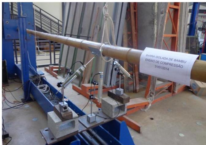
Figura 4.1.9: Instalação dos DTs em contato com as placas equalizadoras.
