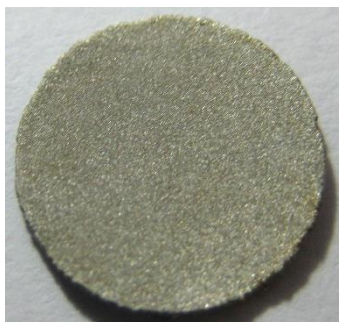
Figura C.1: Depósito de níquel obtido sem adição de orgânico.
