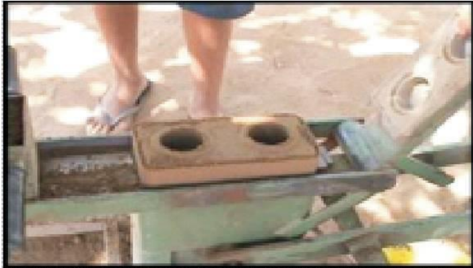
Figura 19: Tijolos saindo da prensa. Fonte: FERREIRA et. al., 2007.
