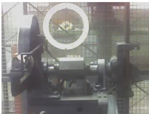
Figura 34: Prensa utilizada no ensaio de compressão.
