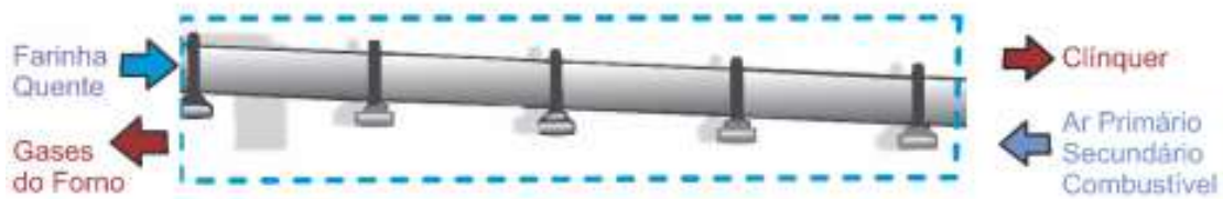
Figura 7 - Esquema do forno rotativo. Fonte: Próprio autor.
