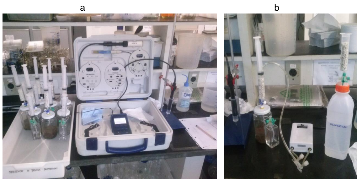
Figura 4.17 - Detalhamento do equipamento utilizado na medição da condutividade elétrica na solução contida (a) e aeração os respirômetros (b)
