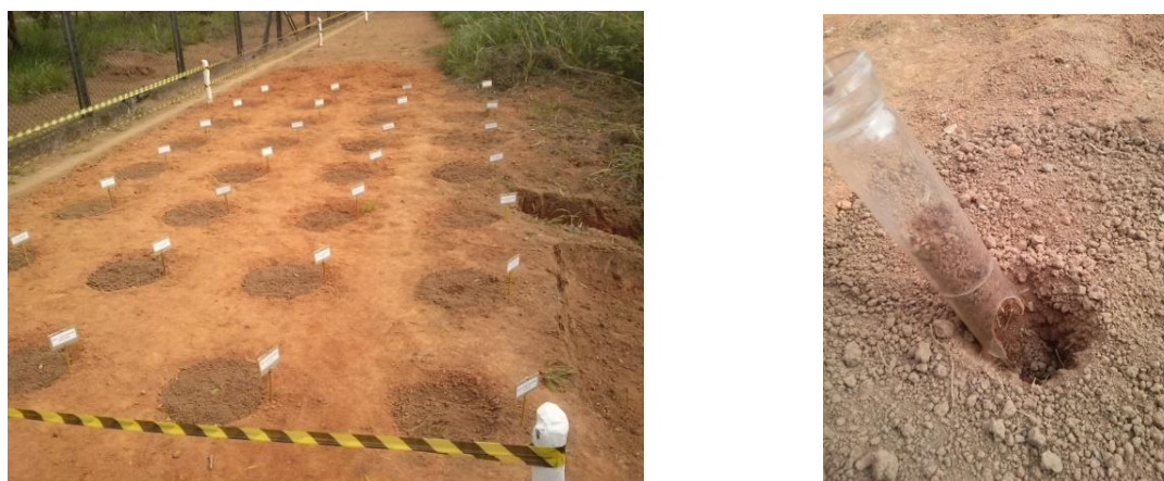
Figura 4.12 - Detalhe do preenchimento das covas (a) e coleta das amostras (b)
