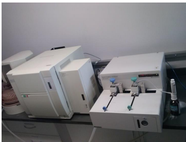
Figura 4.7 - Detalhe do equipamento utilizado na quantificação do teor de carbono orgânico total
