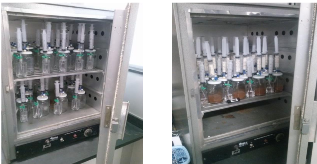
Figura 4.16- Detalhe da estrutura utilizada na incubação dos lodos e do resíduo orgânico no solo
