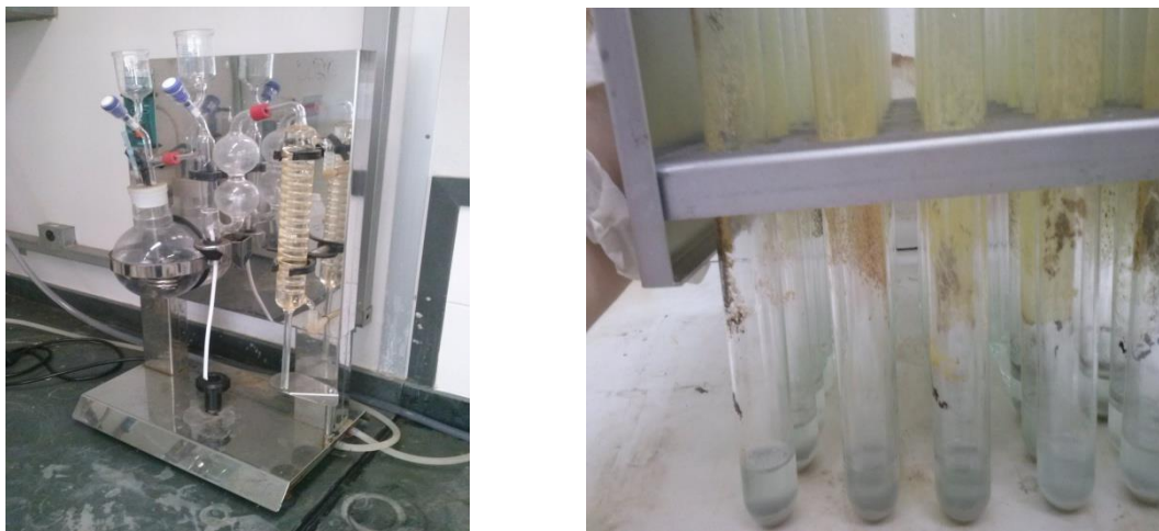
Figura 4.6 - Destilador de Kjeldahl utilizado na quantificação do teor de nitrogênio (total/inorgânico) nas amostras
