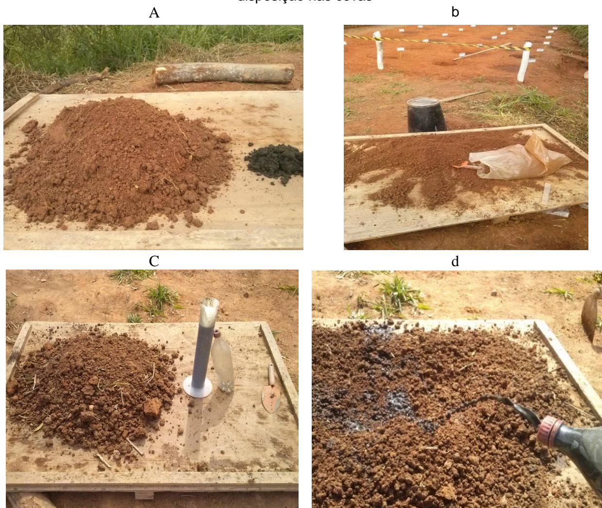
Figura 4.11 - Detalhe do processo de mistura dos lodos e resíduo orgânico no solo que sofreram desaguamento (sólido) (a e b) e não desaguado (líquido) (c e d), antes de sua disposição nas covas
