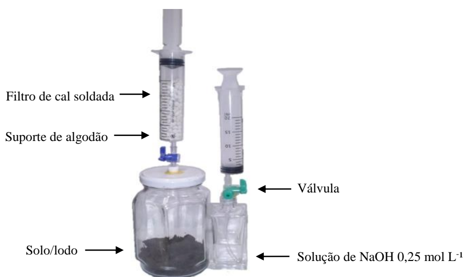
Figura 4.15 - Respirômetro de Bartha
