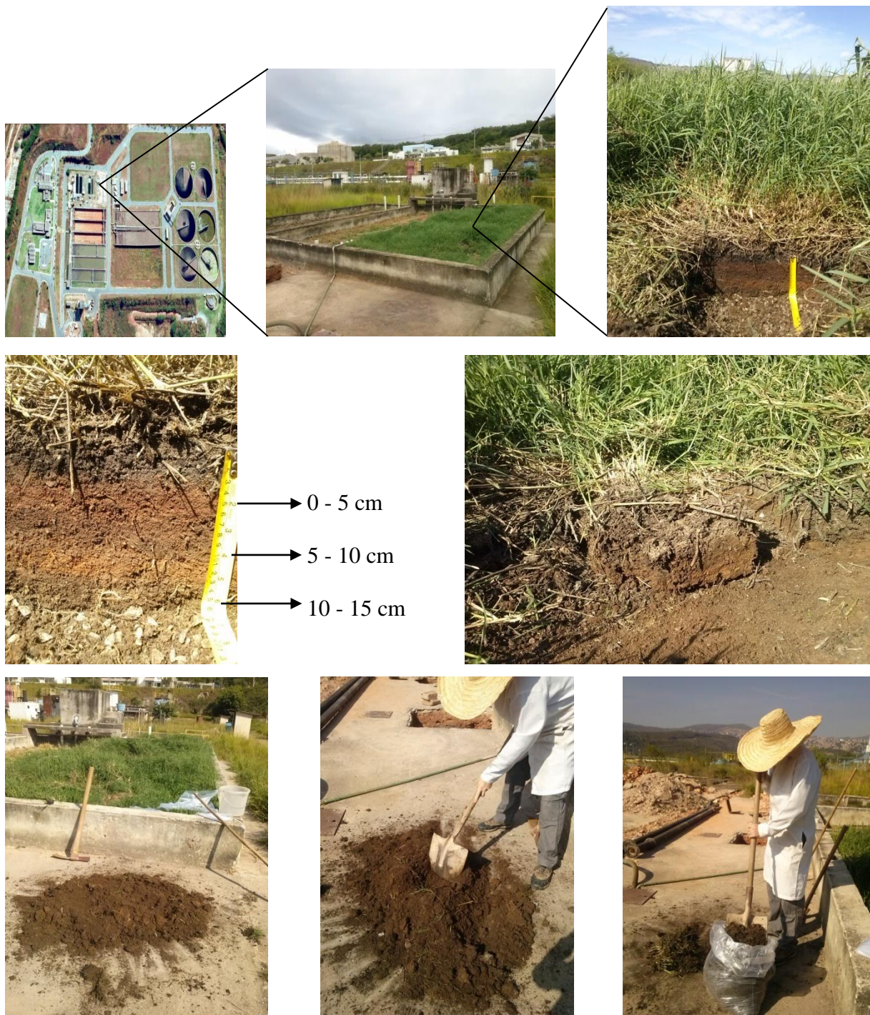
Figura 4.2 - Detalhes da localização do resíduo orgânico acumulado, da sua coleta no SAC-EV e do seu manejo para uso no experimento
