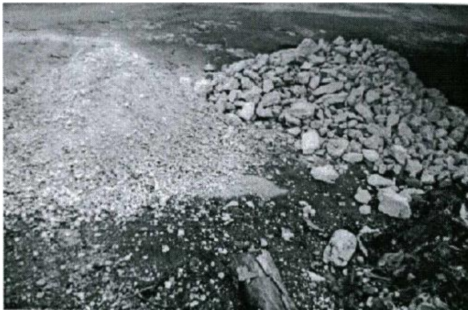
Figura 3.3 - Resíduo de concreto após a britagem primária Fonte: BAZUCO, 1999, p.44.
