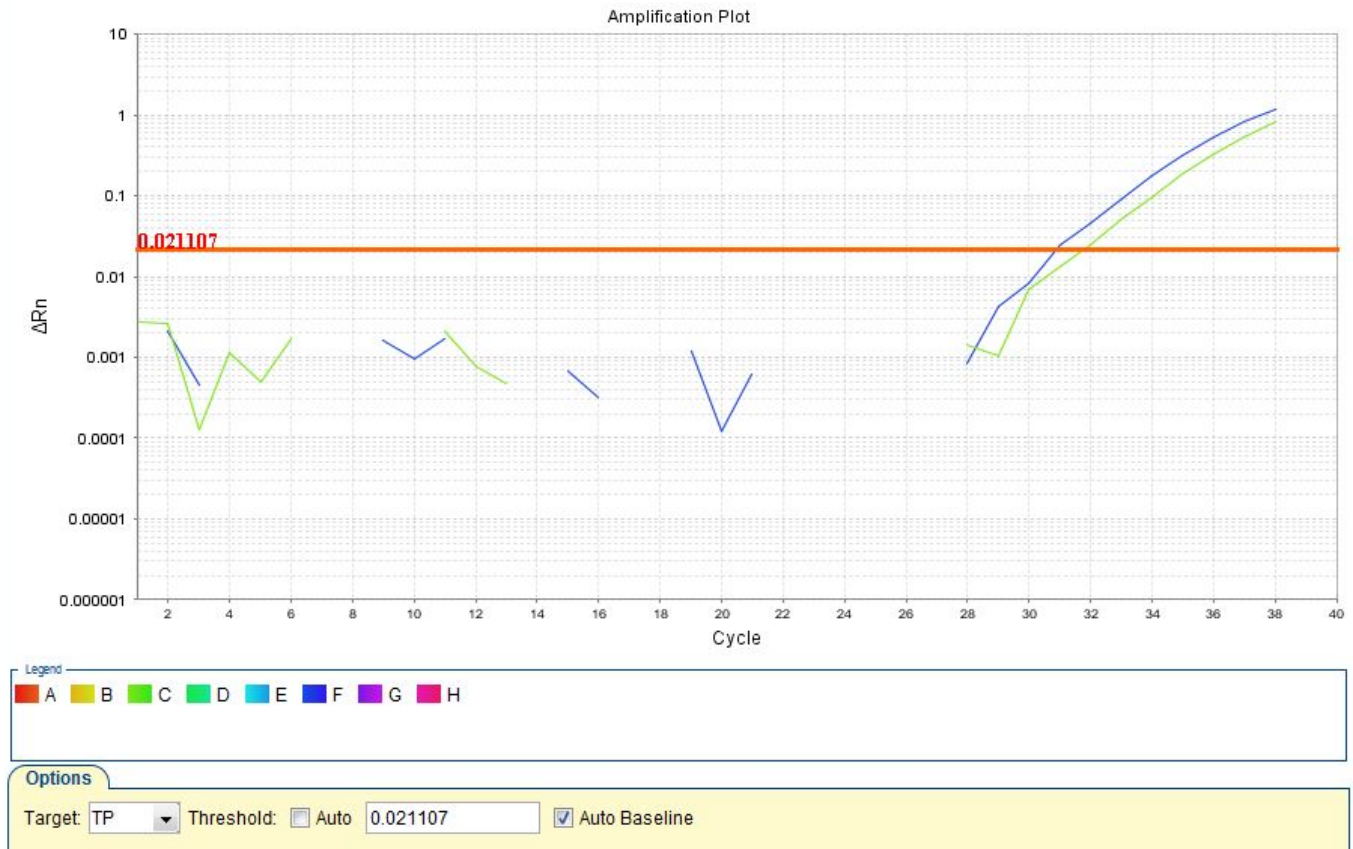
Figura 10: Curvas de amplificação da reação de PCR em tempo real T.pallidum . 162 cópias de DNA/ \mu L utilizado na reação. Singleplex : Ct do TP: 30,97; Multiplex , para o HHV 1, HHV 2 e T.pallidum : Ct do TP de 31,76. Foi utilizado TaqMan® Multiplex MasterMix (Thermo Fisher, Carlsbad, Estados Unidos da América) Marcação da sonda: FAM. Referência passiva: Mustang Purple® (Thermo Fisher). Ciclagem utilizada: 50°C por 2 minutos, 95 °C por 10 minutos, 45 ciclos de 20 segundos a 95°C, 1 minuto a 60°C.
