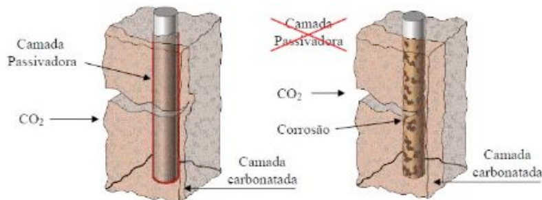
Figura 4: Avanço da frente de carbonatação .
