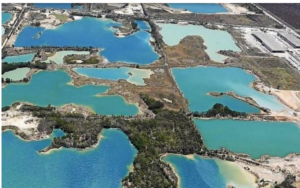
Figura 3: Lençol freático exposto devido a extração de areia
