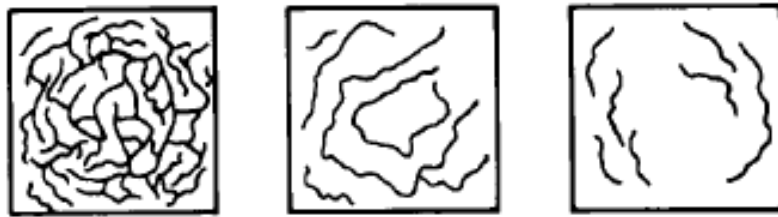
Figura 26: Aspectos assumidos pelo gretamento do esmalte cerâmico. Fonte: NBR 13818 (1997).
