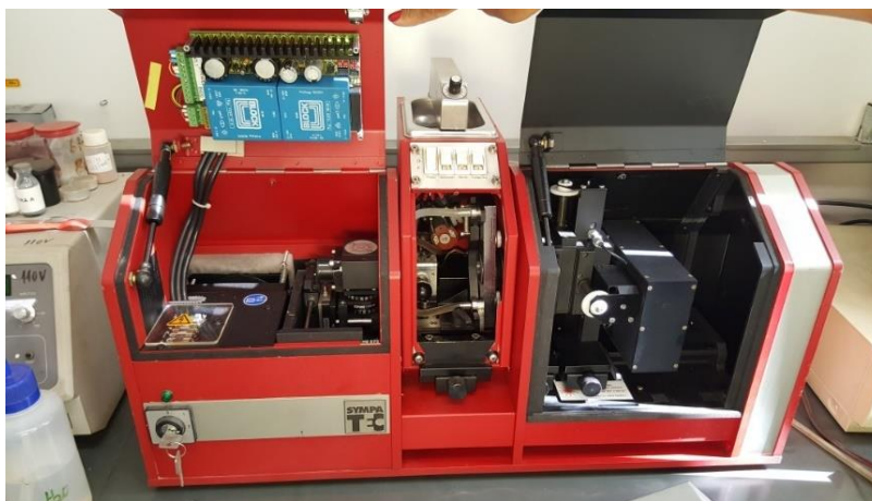
Figura 03 – Granulômetro a Laser Sympatec Helos Vectra – Equipamento aberto.
