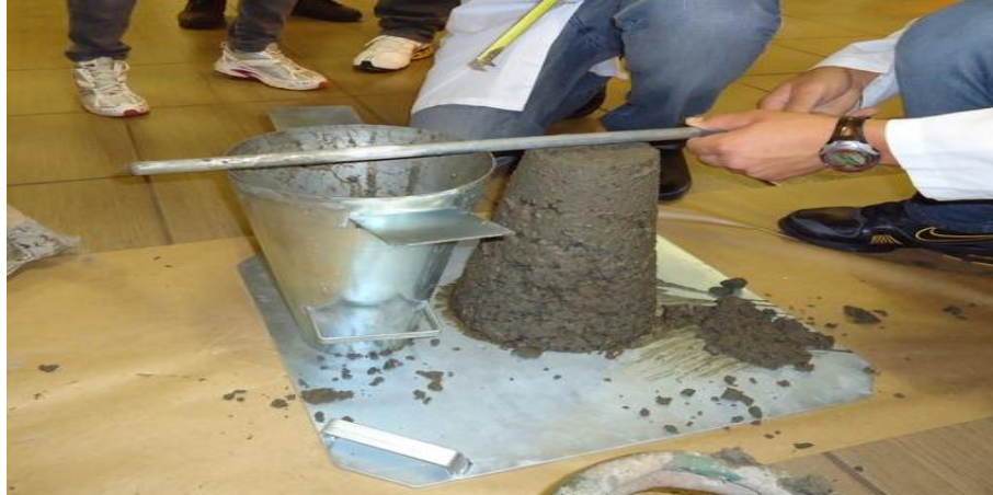
Figura 4.19:Realização de ensaio de abatimento de tronco de cone.
