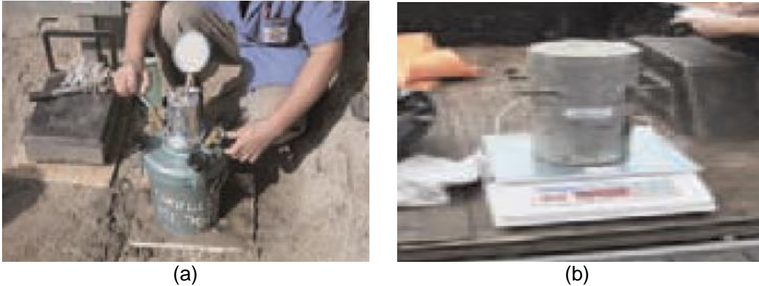
Figura 4.21: Ensaio para recebimento de concreto fresco: (a) Ensaio de determinação de teor de ar incorporado, (b) ensaio de determinação de massa específica do concreto.
