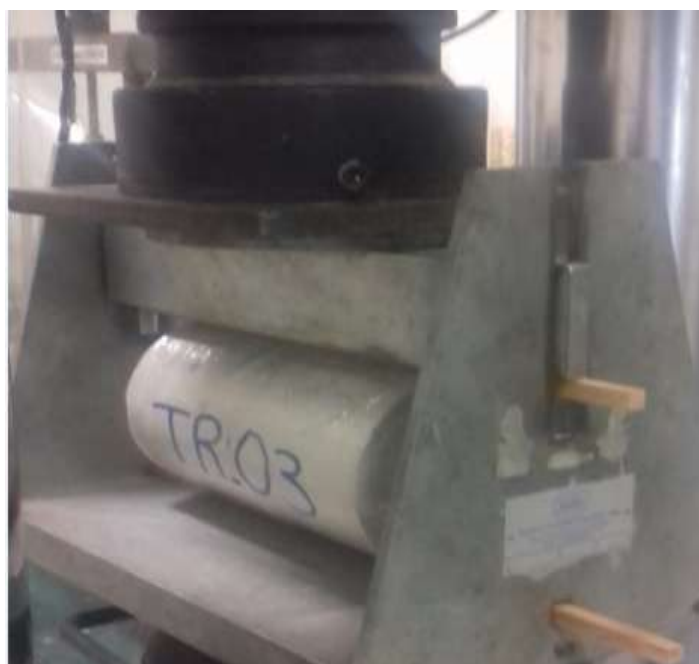
Figura 5.6 - Rompimento do corpo de prova pela tração indireta
