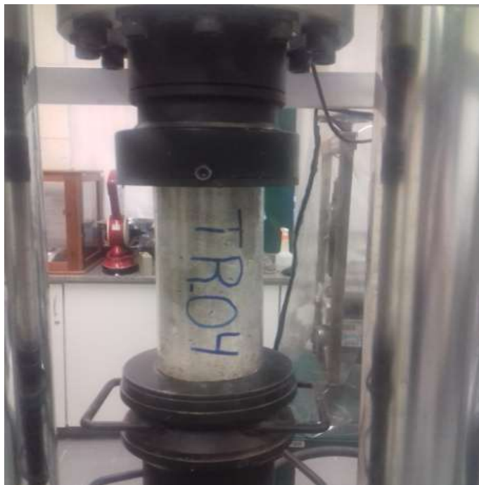
Figura 5.4- Rompimento do corpo de prova por ensaio da compressão axial
