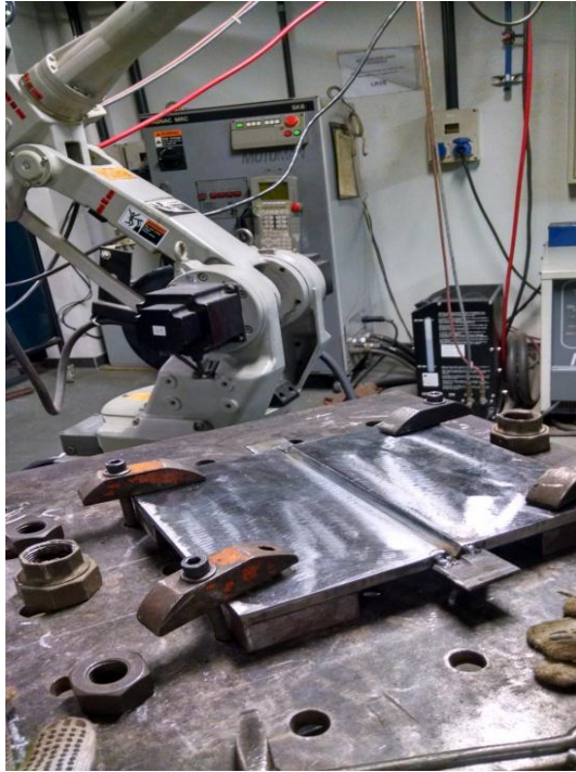
FIG. 22 - Peça fixada à mesa de soldagem para evitar distorção.
