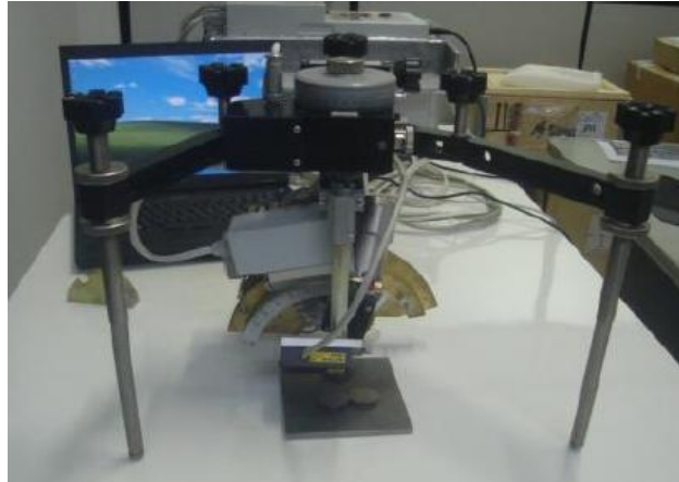
FIG. 27 - Difratorômetro Portátil utilizado para análises das tensões residuais.
