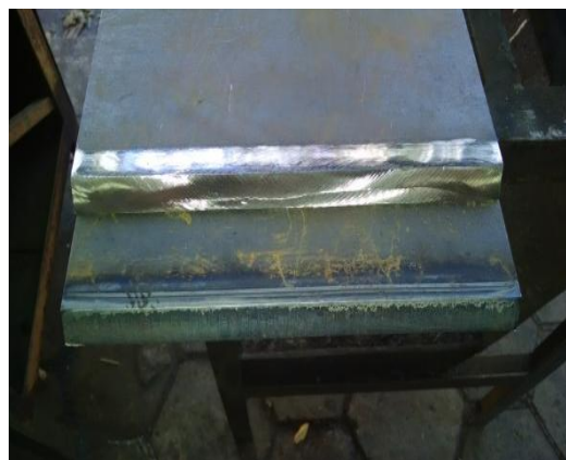
FIG. 15 - Comparação entre a chapa após polimento e a chapa após o corte
