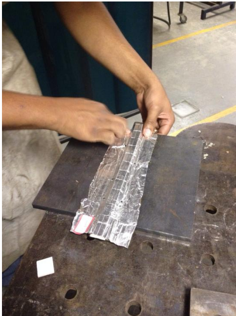
FIG. 18 - Utilização do backing cerâmico
