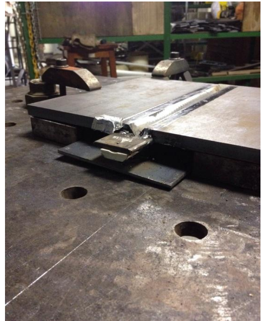
FIG. 19 - Corpo de prova preparado para soldagem.
