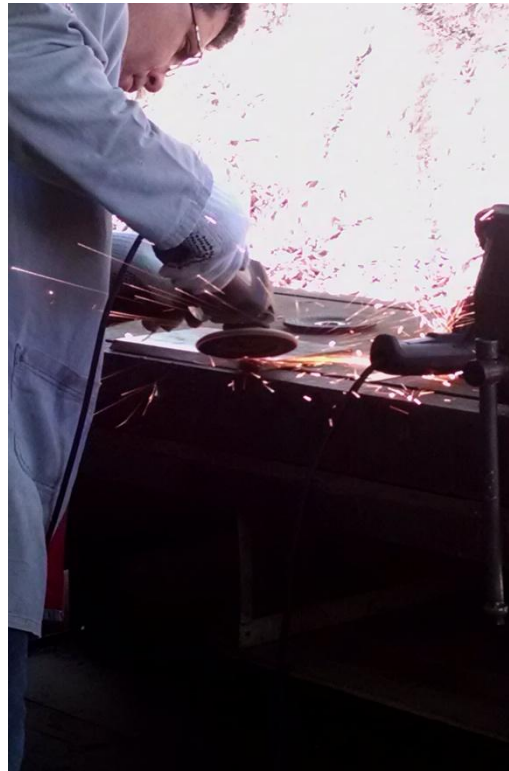
FIG. 13 - Lixamento das peças após o corte
