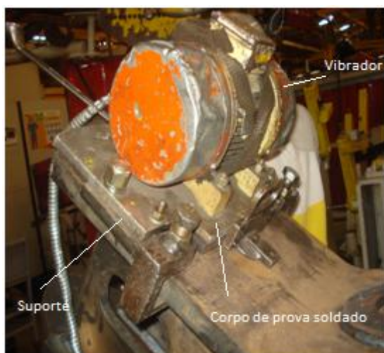
FIG. 25 - Vibrador acoplado ao corpo de prova.
