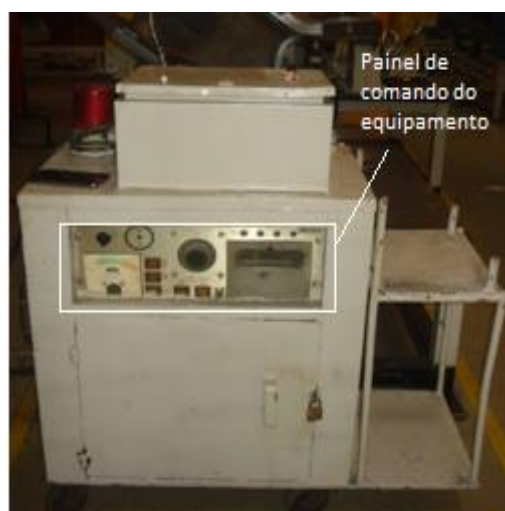
FIG. 26 – Equipamento típico para alívio de tensões por vibração.
