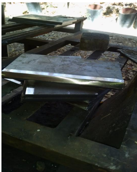
FIG. 14 - Chapa após corte e lixamento.
