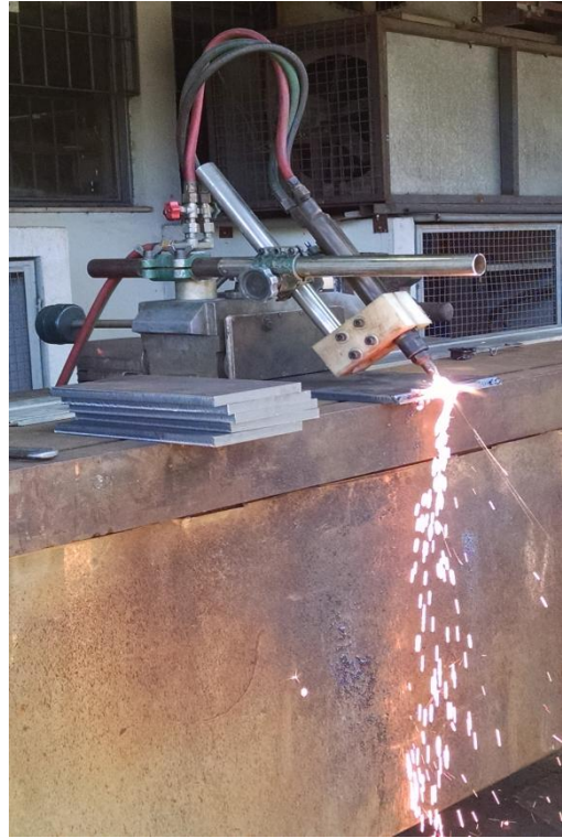
FIG. 11 - Execução do oxi-corte.
