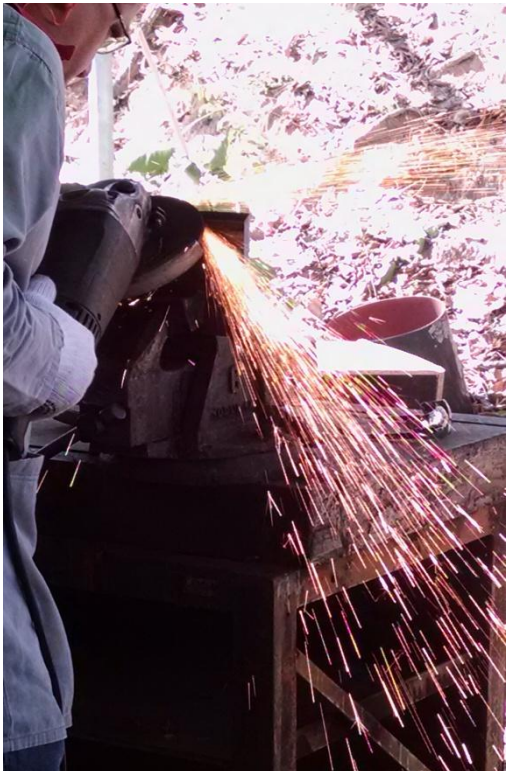
FIG. 12 - Lixamento das peças após o corte.
