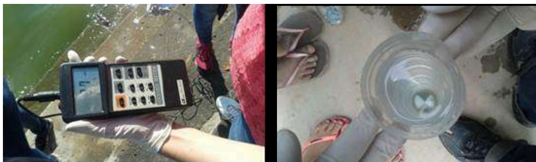
Figura 4: Equipamentos utilizados na medição dos parâmetros físico-químicos da água. À esquerda o oxímetro e à direita o turbidímetro.
