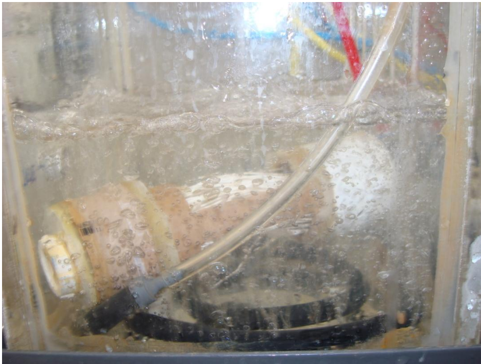
Figura 4.5 – Fotografia da aeração aplicada no tanque biológico e na membrana durante etapa de avaliação da melhor idade de lodo
