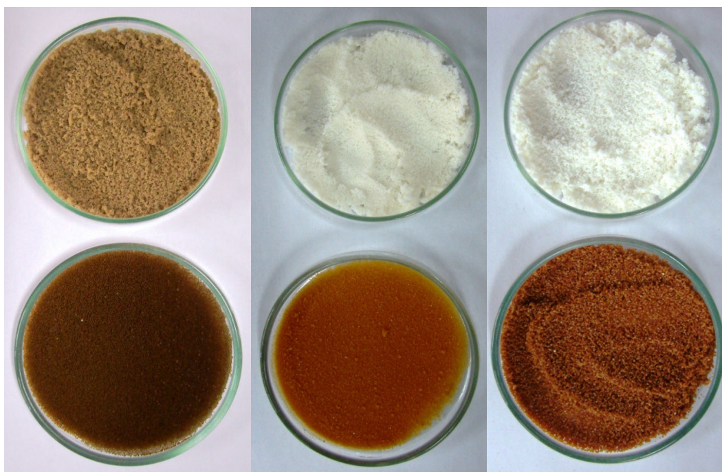
Figura 24: Resinas PK208, PA306S e PA408 antes (acima) e depois (abaixo) dos tratamentos.
