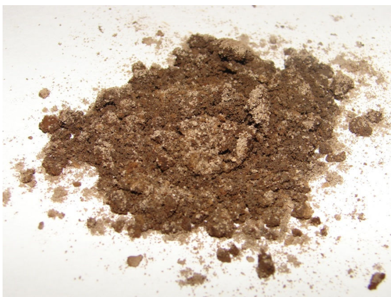
Figura 25: Resina CT275DR após oito horas de reação em reator de mistura.
