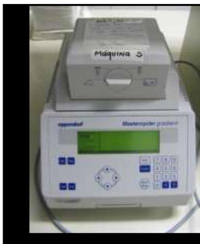
**Figura 8** – Termociclador. Máquina onde há a amplificação de produtos de PCR.
