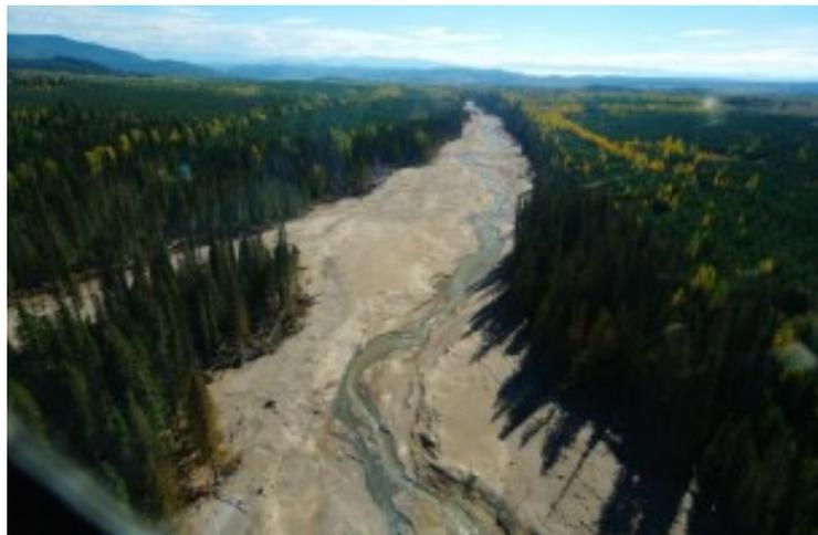
**Figura 3.3:** Erosão e inundação causada pela onda inicial de inundação em Mount Polley (Canadá) – 2015
