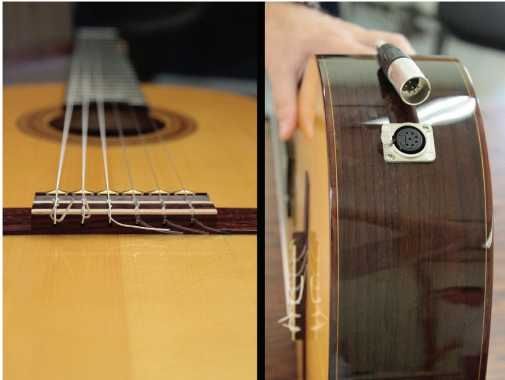
Figura 3 – Violão Yamaha equipado com captação hexafônica e conector multivias para aquisição independente dos sinais das cordas.
