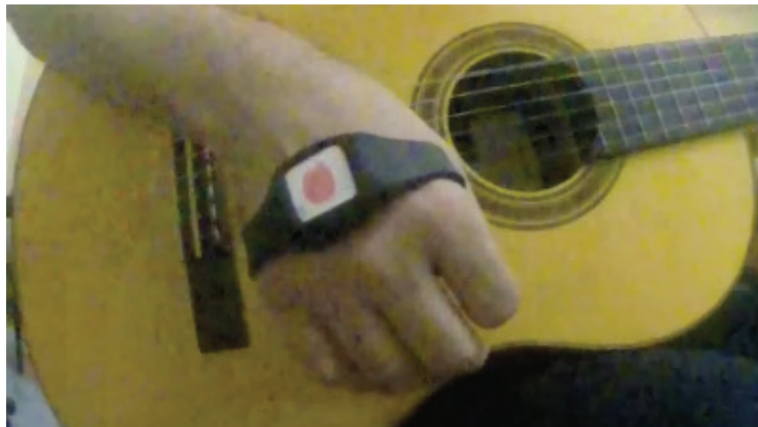
Figura 19 – Posição do IMU na mão de um performer. Todos os músicos utilizaram a mesma orientação do sensor.
