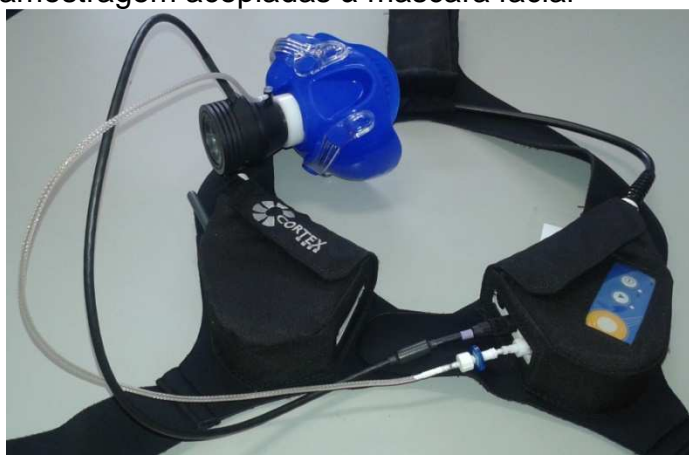
FIGURA 4: Analisador de gases portátil inserido no colete, com a turbina de volume e a linha de amostragem acopladas à máscara facial
