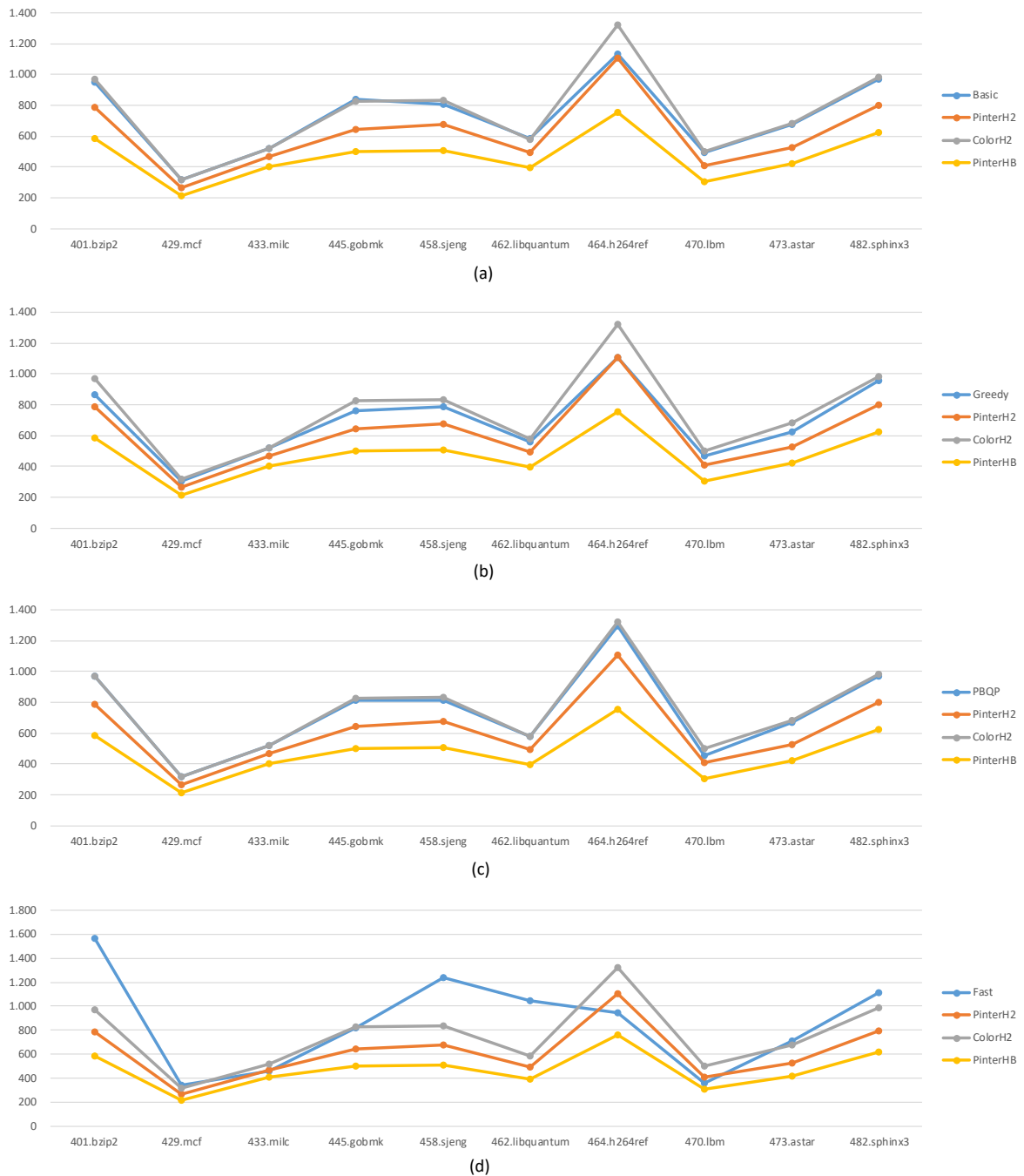
Figura 7.5. Comparação entre cada um dos métodos do LLVM e as abordagens implementadas. Comparação das abordagens com os métodos: (a) Basic ; (b) Greedy ; (c) PBQP e (d) Fast .
