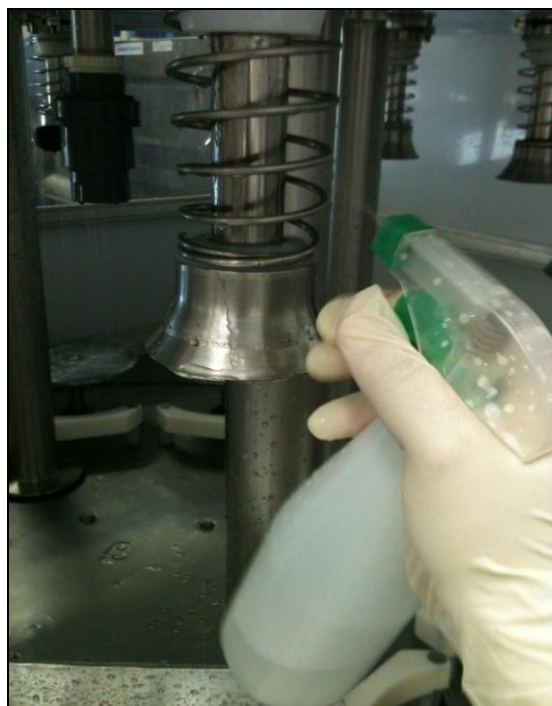
Figura 8: Procedimento de Assepsia nos bicos da enchedora com álcool a 70%.
