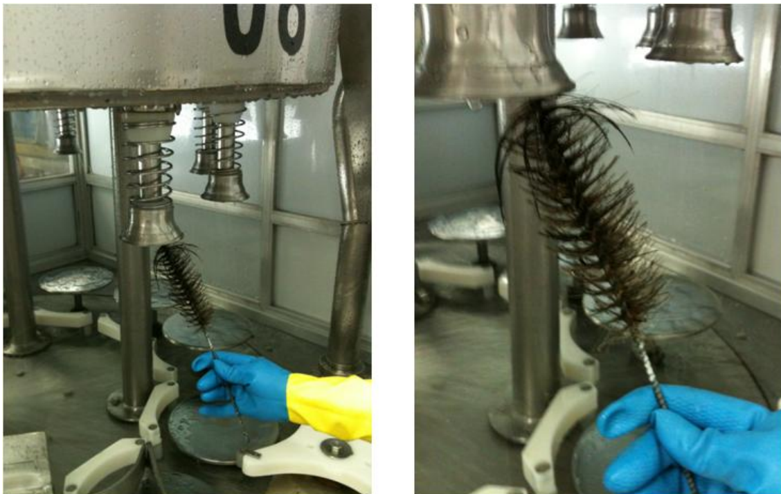
Figura 7: Escova de gaspilhão para higienização interior dos bicos da enchedora de garrafões de 20 litros.
