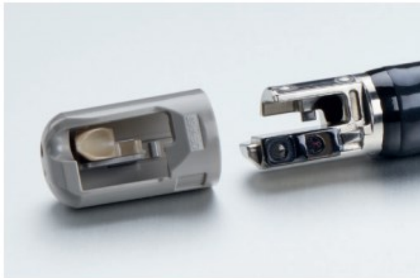
Figura 8 - Duodenoscópio com proteção descartável do mecanismo de elevador
