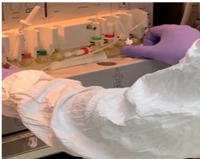
Figura 5 - Encaixe do cassete no módulo (das extremidades ao centro), UPR, 2020-2021
