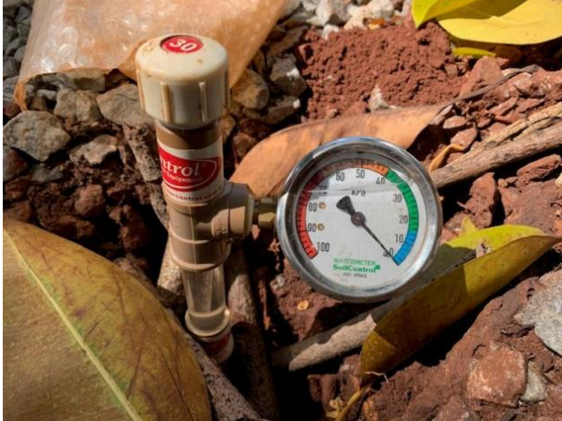
Figura 22 – Tensiômetro em campo para medir a água retida no solo para as plantas
