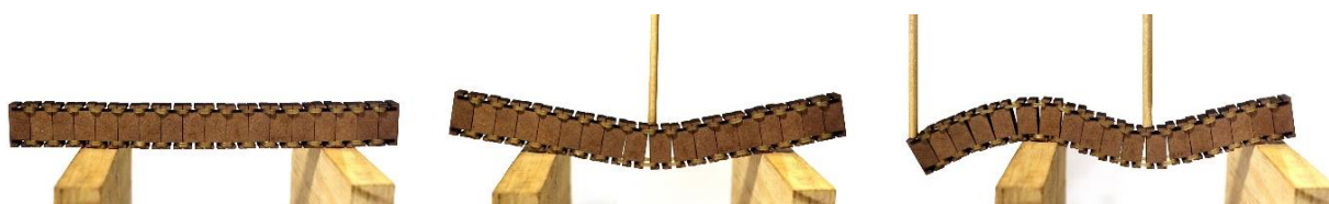
Figura 13 – Vigas apoiadas e com balanço.
