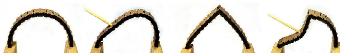
Figura 18 – Arcos plenos e ogivais.
