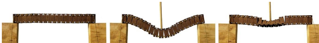
Figura 11 – Viga bi engastada com reforços apenas em zonas sob tração.
