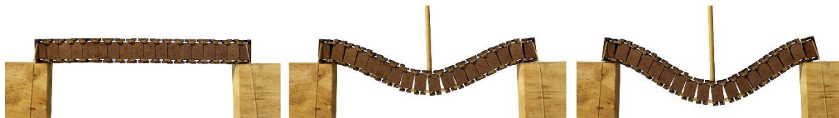
Figura 10 – Viga bi engastada contínua.
