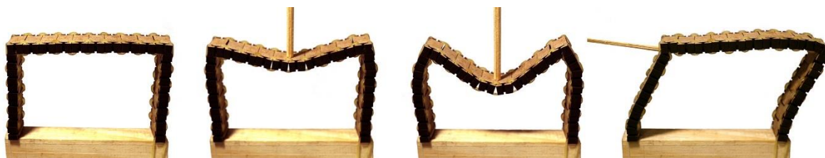
Figura 20 – Pórticos com cargas verticais e laterais.
