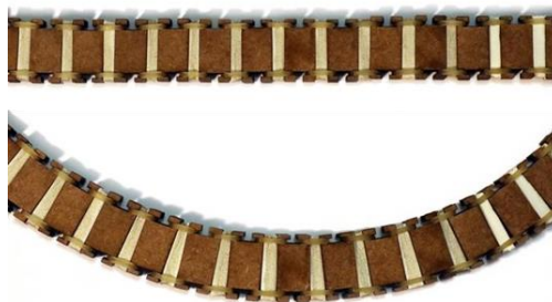
Figura 07: Trechos de viga com espaçadores em EVA evidenciando os esforços de compressão. Fonte: LOBOSCO; CÂMARA, 2018.
