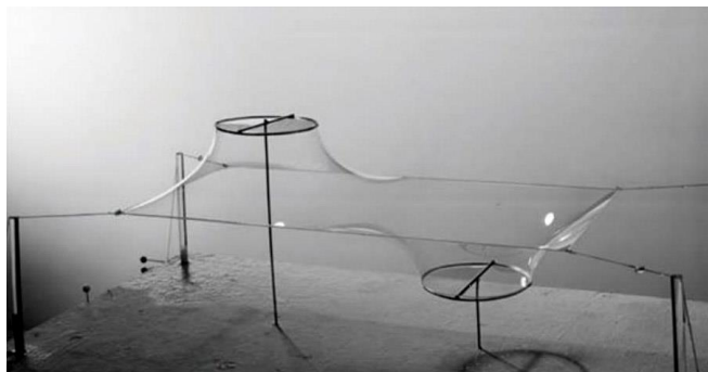
Figura 01: Estudos com bolhas de sabão para encontrar a geometria ideal de uma estrutura tensionada. Fonte: OTTO, 1961 apud WHITEHEAD, 2019.
