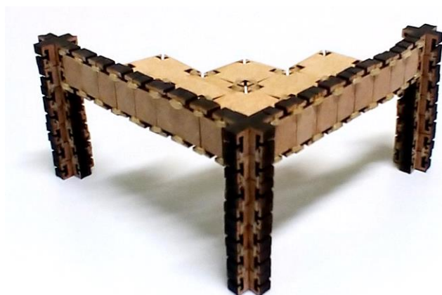
Figura 13: Montagem do protótipo final demonstrando a construção de pilares vigas e lajes. Fonte: Autores.
